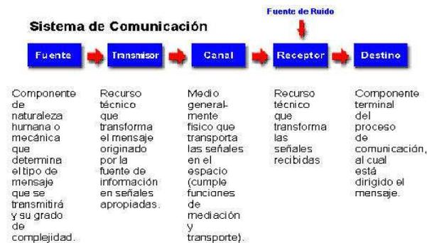
Fig. 3.2 Esquema de un sistema de comunicación.
