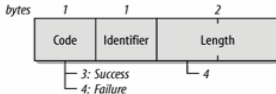
Figura 4.7. Paquetes: EAP-Success y EAP-Failure
