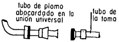
UNION DEL TUBO DE PLOMO CON EL DE LA TOMA DE ACERO GALVANIZADO
