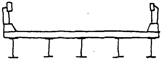
Losa sobre viguetas < 15m
