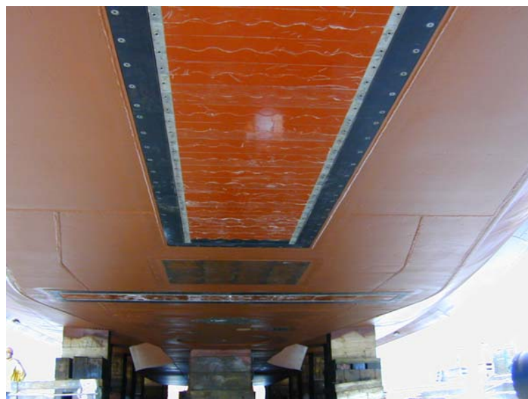
Figura A.5. Vista de la quilla del RV SONNE, mostrando la góndola donde está montada la ecosonda EM120. superior: vista hacia proa; inferior: vista hacia popa.
