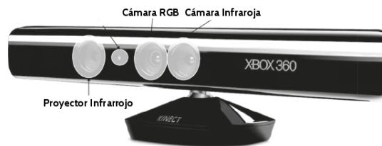
Figura 5.1: Sensor Kinect TM . Imagen extraída de [26].
