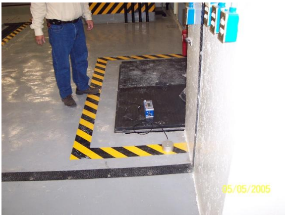
Colocación del sismógrafo en las juntas constructivas
