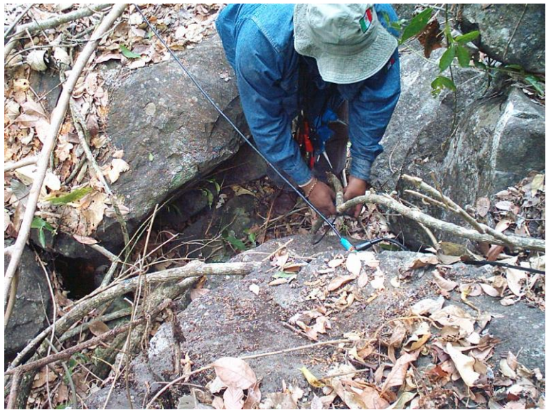
Momento en que se realiza la conexión de los geófonos al cable sísmico por el que se trasmite la señal.
