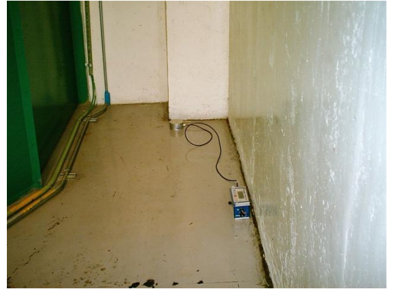
Ubicación de sismógrafo en la sala de fuerza , sobre el sensor triaxial se encuentra una bolsa con arena para tener mejor acoplamiento con el piso
