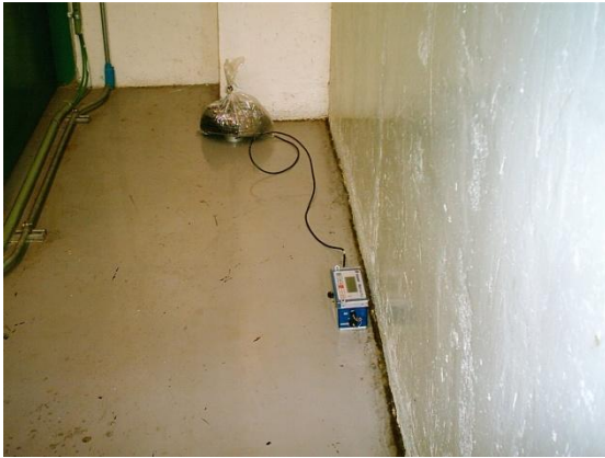
Ubicación de sismógrafo en la sala de fuerza , sobre el sensor triaxial se encuentra una bolsa con arena para tener mejor acoplamiento con el piso
