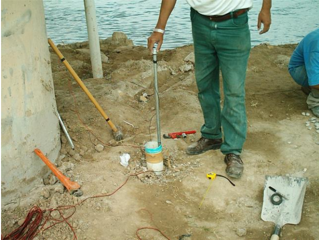
Mediciones para el control de profundidad y adecuada ubicación de la extensión de martillo que funcione como fuente sísmica
