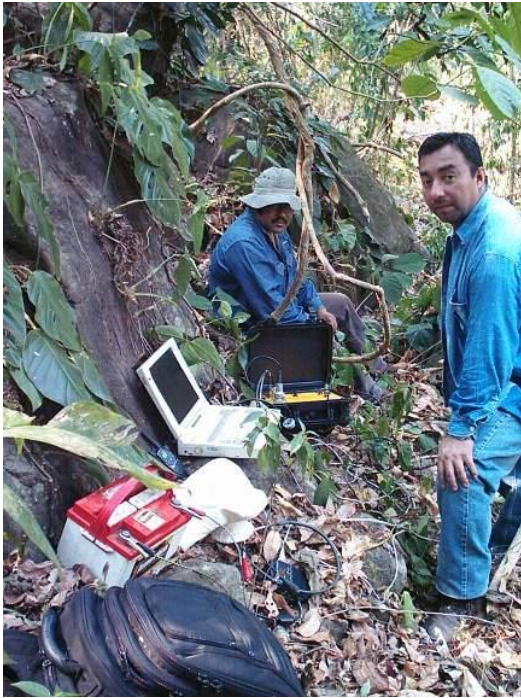
Sismógrafo Seistonix Ras-24, empleado durante la toma de registros sísmicos
