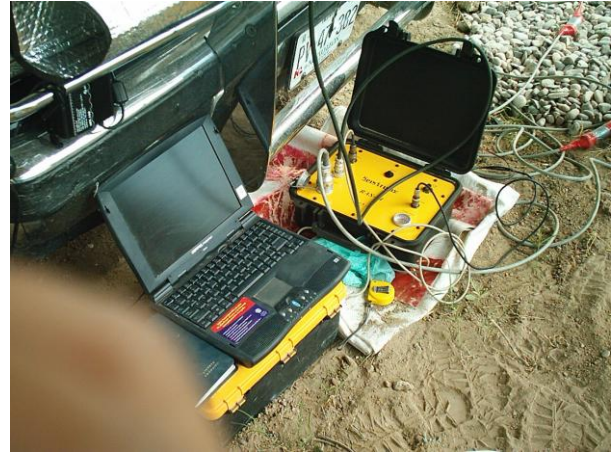
Sismografo Seistronix Ras-24, acoplado a la computadora pentium, en la que se almacenaron los registros sísmicos para su posterior procesamiento
