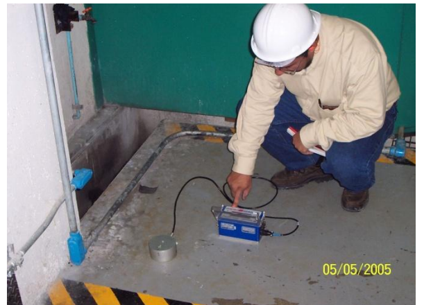
Colocación del sismógrafo en las juntas constructivas
