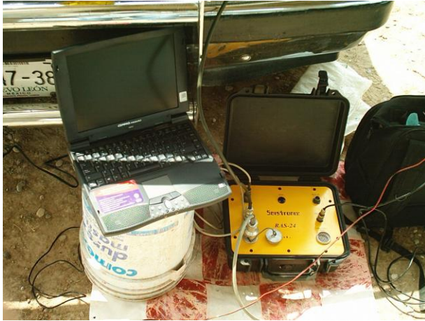
Sismografo Seistronix Ras-24, acoplado a la computadora pentium, en la que se almacenaron los registros sísmicos para su posterior procesamiento
