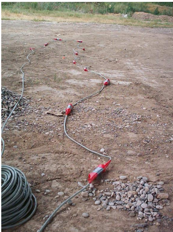
Sonda de geofonos empleada para el registro de los sismogramas
