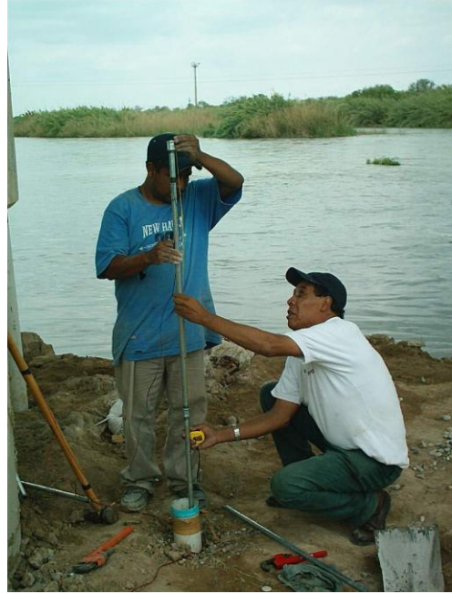
Mediciones para el control de profundidad y adecuada ubicación de la extensión de martillo que funcione como fuente sísmica
