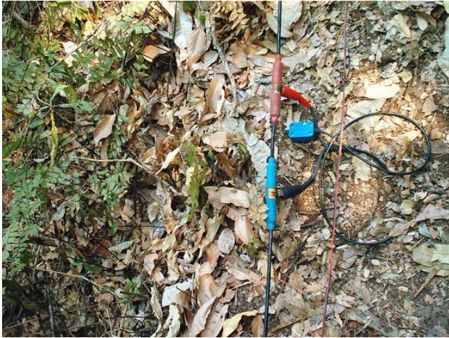
Geófono que registra el paso del frente de onda sísmica, generando un pulso eléctrico que es transmitido a través del cable
