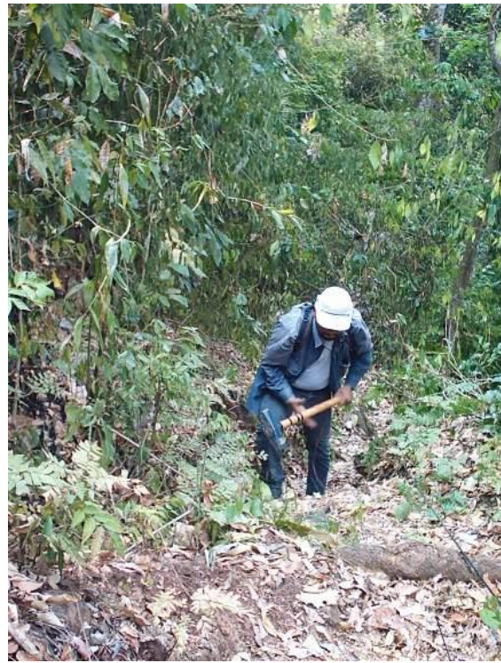
Impacto de martillo que genera la onda sísmica que será registrada
