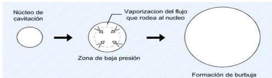
*Fig. 4 Expansión de un núcleo de cavitación.*
