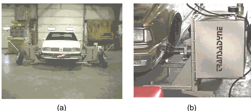
Figura II.4. (a) Dinamómetro de chasis carente de rodillos; (b) detalle del acoplamiento directo al tambor de la flecha motriz.
