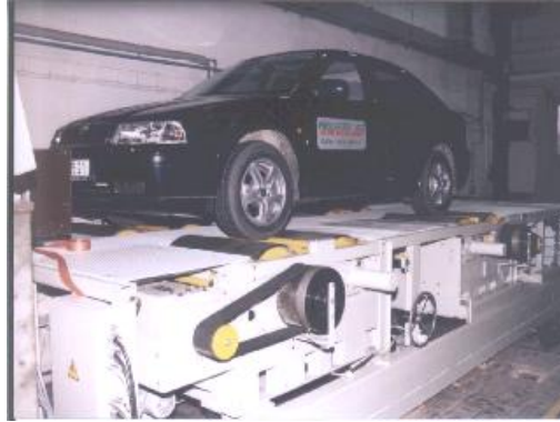
Figura II.5. Dinamómetro de chasis en fábricas de automóviles.
