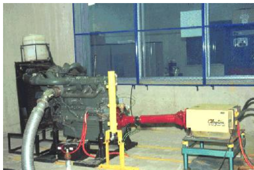
Figura II.6. Aspecto del acoplo de un dinamómetro de banco.
