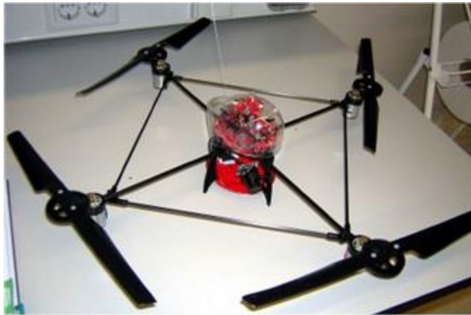
Figura. 11 Cuadrocoptero usado para el proyecto [21].
