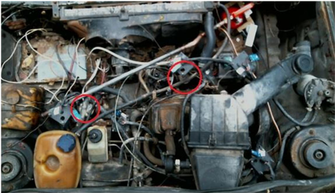
Figura 64. Inicio de la prueba colocando las fuentes de incendio.
