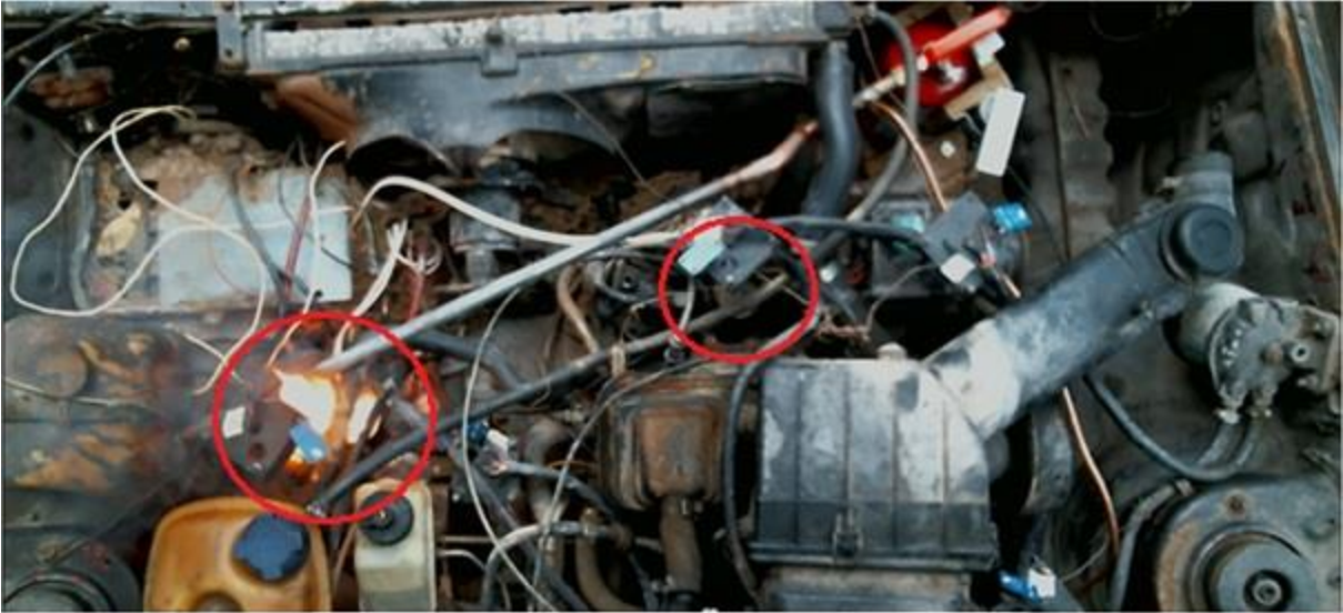
Figura 65. Momento en que se accionan las dos fuentes de incendio.
