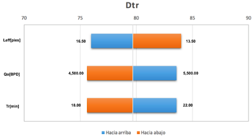
Figura 6.8 Análisis de sensibilidad tipo tornado para la ecuación de tiempo de residencia para tratadores horizontales
