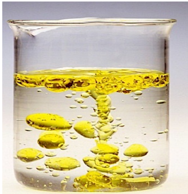
Figura 1.3 Diferencia de densidades entre el agua y el aceite.
