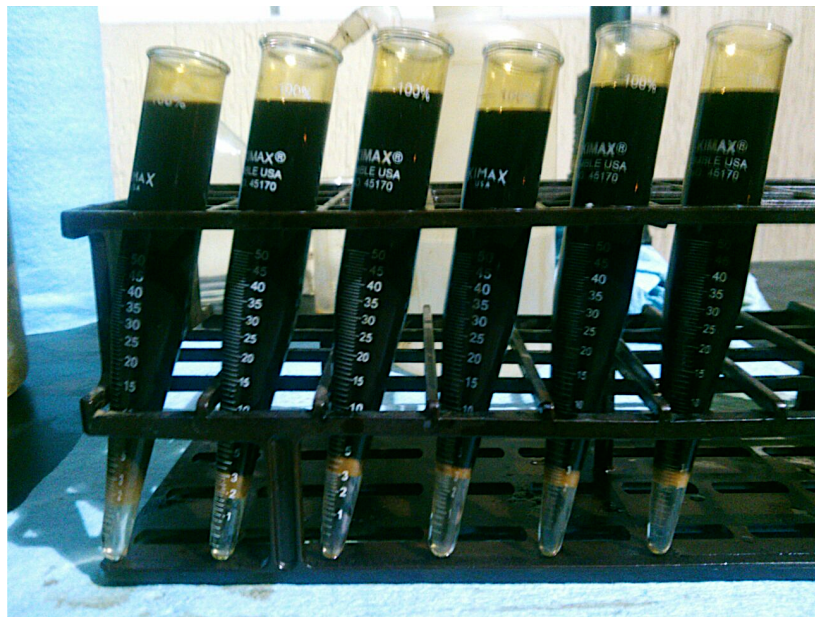
Figura 2.5 Ejemplo de una prueba de botella.
