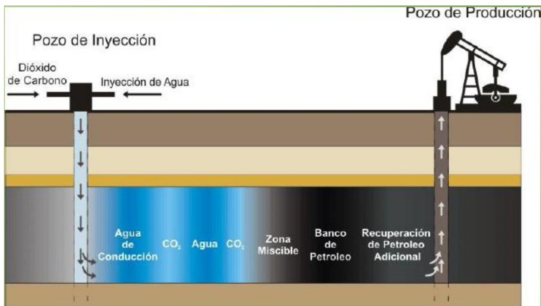
Figura 5.5 Proceso de Recuperación con inyección de CO 2 .
