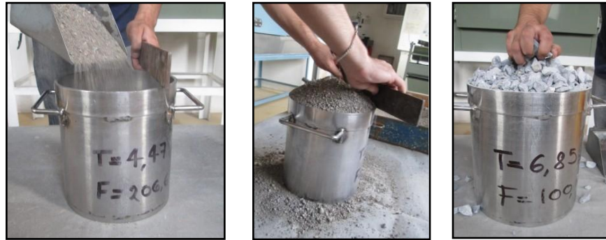
Figura 34: Masa Volumétrica de los Agregados. (Fuente: Lab. de Agregados CEMEX)
