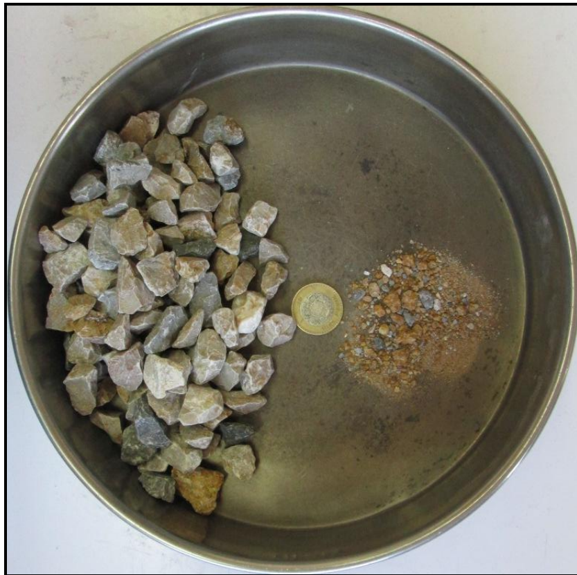
Figura 40: Pérdida por Intemperismo de una muestra de grava. (Fuente: Lab. de Agregados CEMEX).
