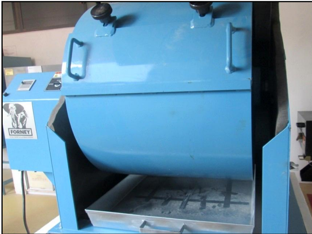
Figura 44: Máquina de Abrasión de los Ángeles. (Fuente: Lab. de Agregados CEMEX)
