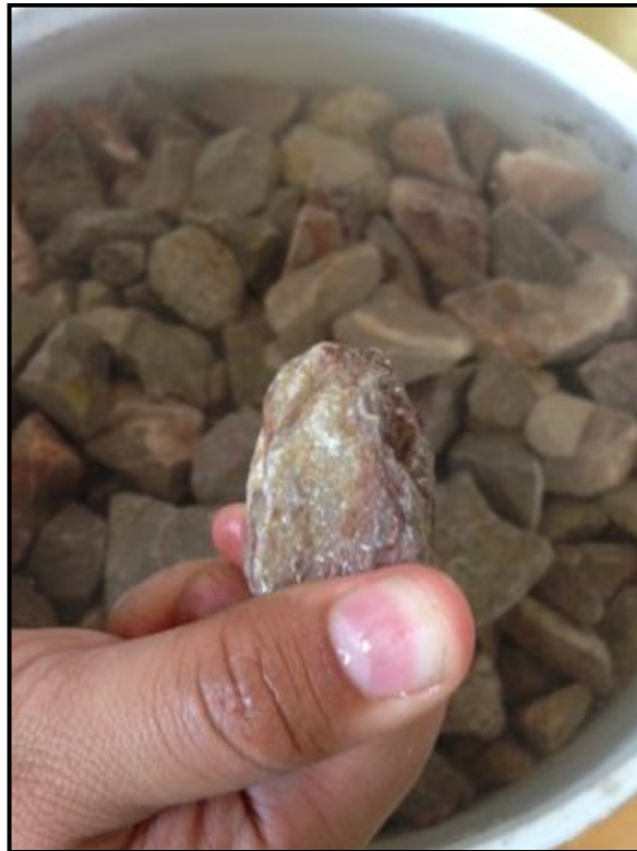
Figura 41: Proceso de desintegración de partículas deleznables y terrones de arcilla en una muestra de grava. (Fuente: Lab. de Agregados CEMEX).
