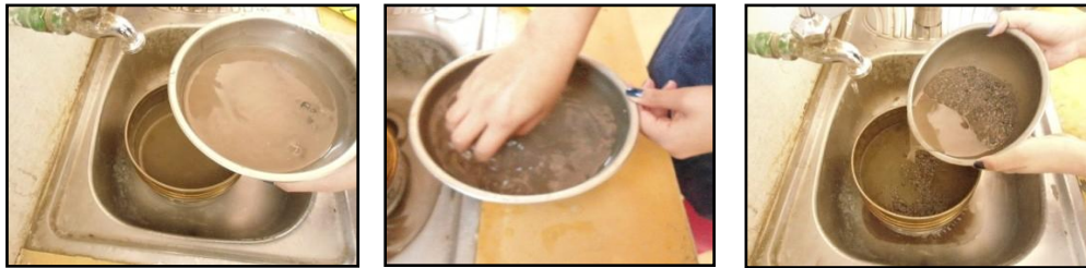
Figura 33: Partículas más finas que la malla No. 200. (Fuente: Lab. de Agregados CEMEX)
