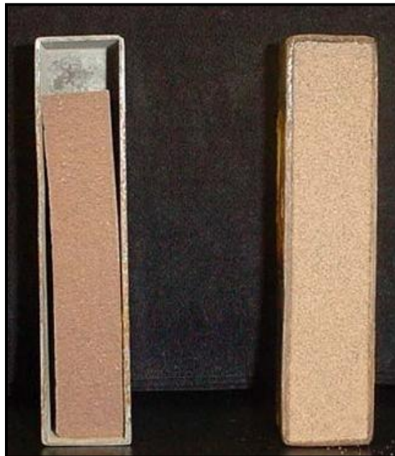
Figura 39: Contracción lineal de un agregado. (Fuente: Lab. De Agregados CEMEX)
