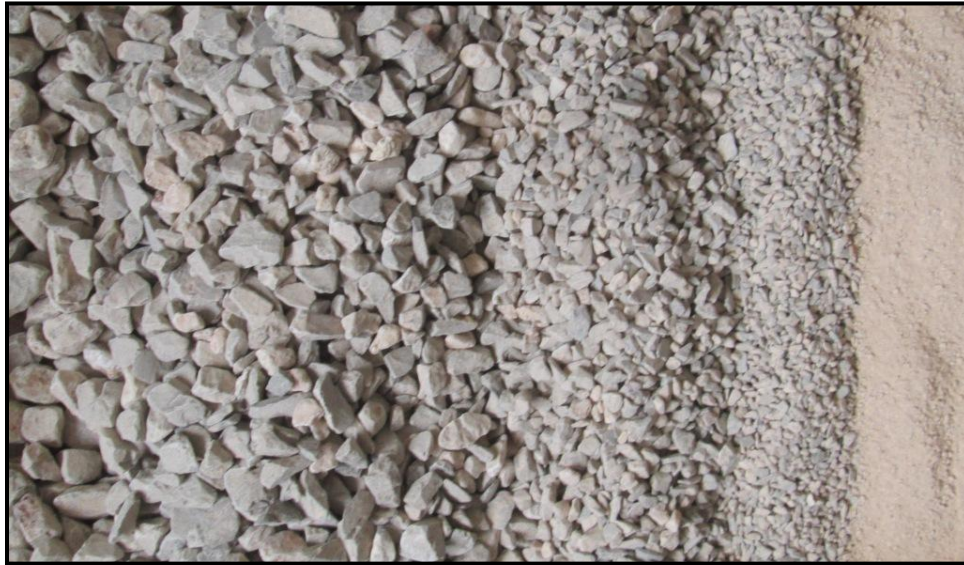
Figura 50: Granulometría del Agregado Grueso de Cantera Cerro Jardín. (Fuente: Lab. de Agregados CEMEX)
