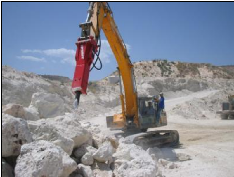
Figura 9: Martillo hidráulico triturando rocas con sobretamaño. (Fuente: Google)
