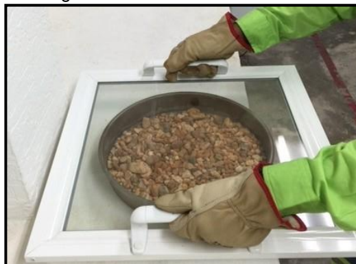
Figura 35: Contenido de Humedad de un agregado. (Fuente: Lab. de Agregados CEMEX)
