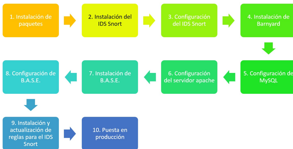
Figura 2.1: Diagrama de bloques instalación y configuración IDS Snort. Fuente: Elaboración propia.
