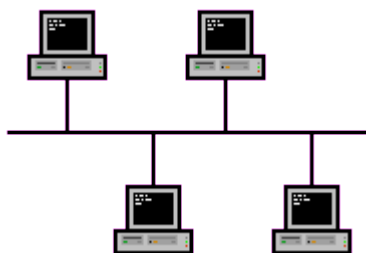
Figura 1.10: Topología tipo Bus. Fuente: wikipedia.com.
