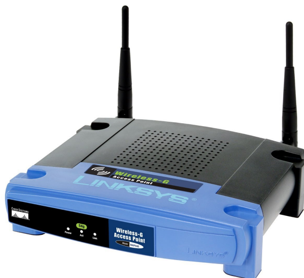
Figura 1.4: Access Point Linksys WAP54G. Fuente: linksys.com.
