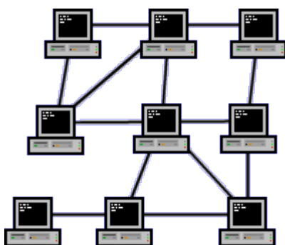
Figura 1.7: Topología tipo Malla. Fuente: wikipedia.com.
