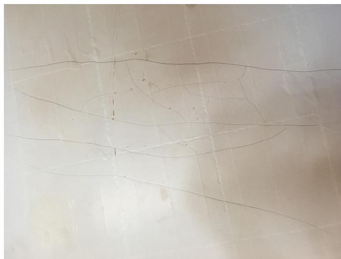
**Fig. 48 Panel roto envejecido, parte posterior**
