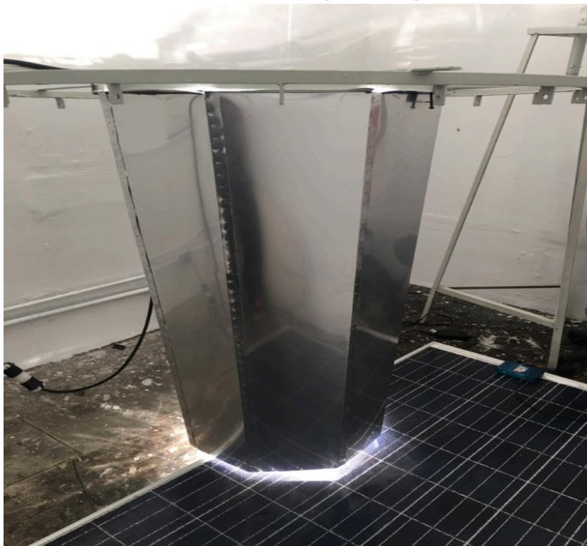
**Fig. 32 Estructura cámara de envejecimiento**
