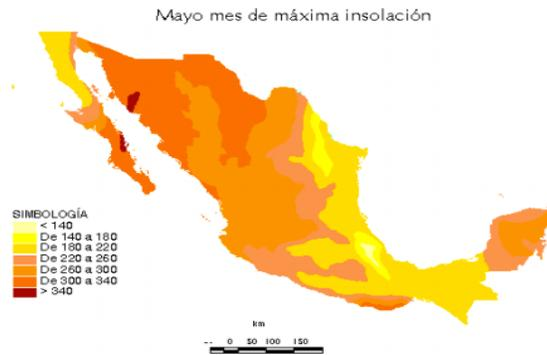
Fig. 14 Irradiancia solar máxima. En  $[W/m^2]^3$
