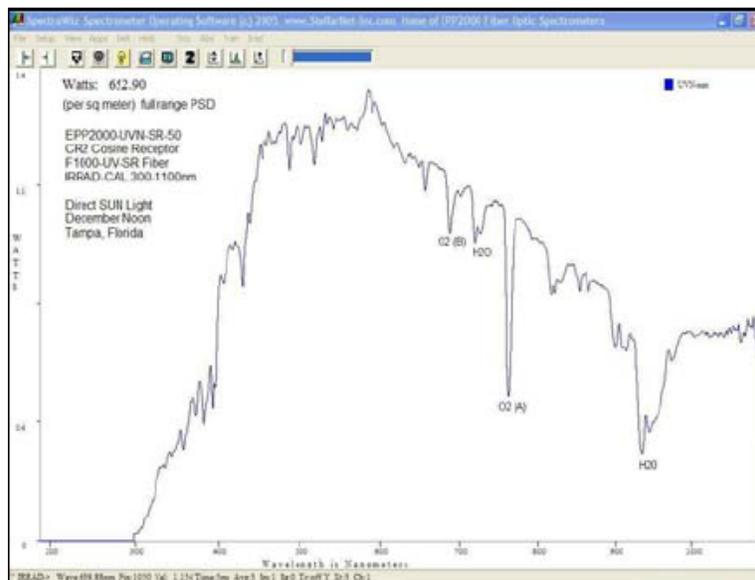
Fig. 18 Medición del espectro solar con espectrorradiómetro StellarNet Blue-wave
