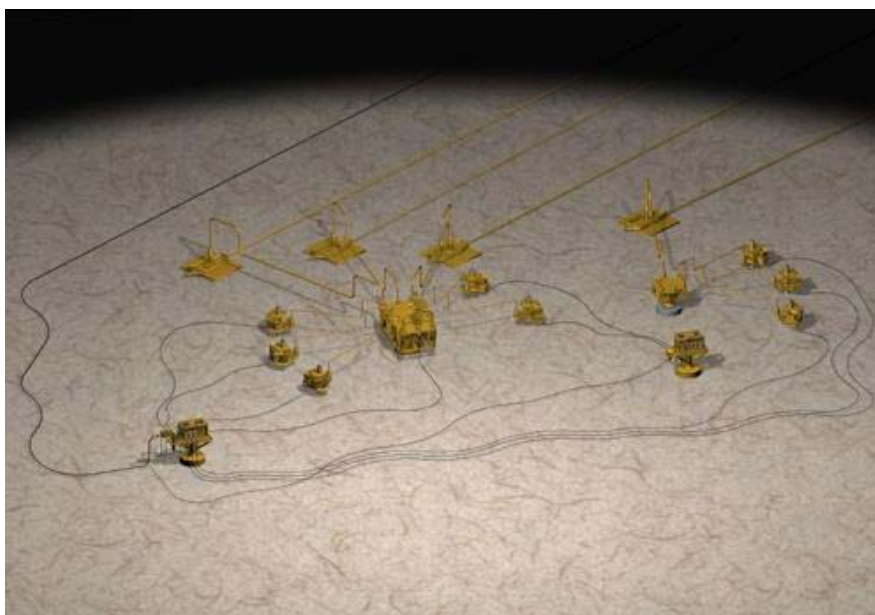
Configuración de desarrollo de un campo en aguas profundas.
