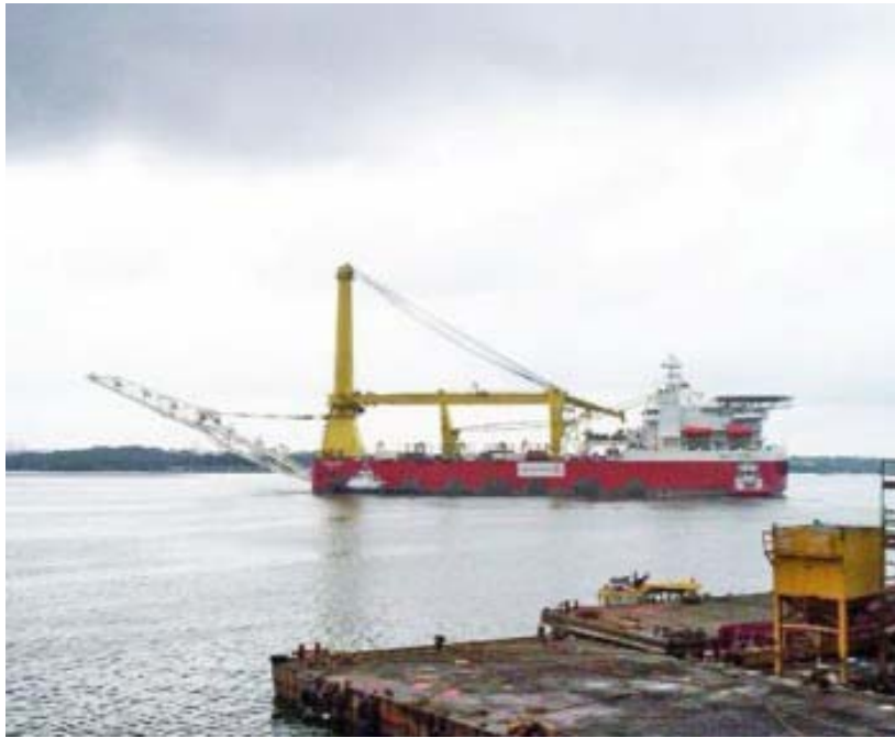
IV. Barco utilizado en el tendido de línea tipo "S".
