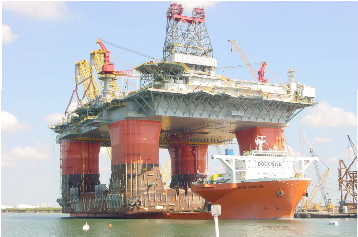
Unidad Flotante de Producción Semisumergible convencional (FPU's-SEMI)
