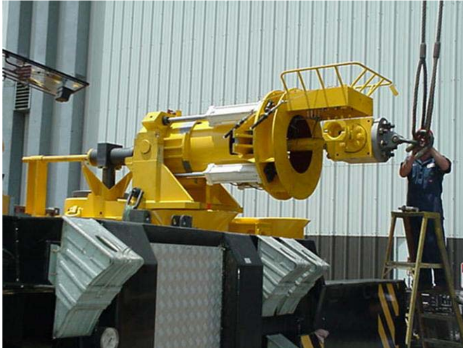
Unida de instalacion de "Stab and Hinge"
