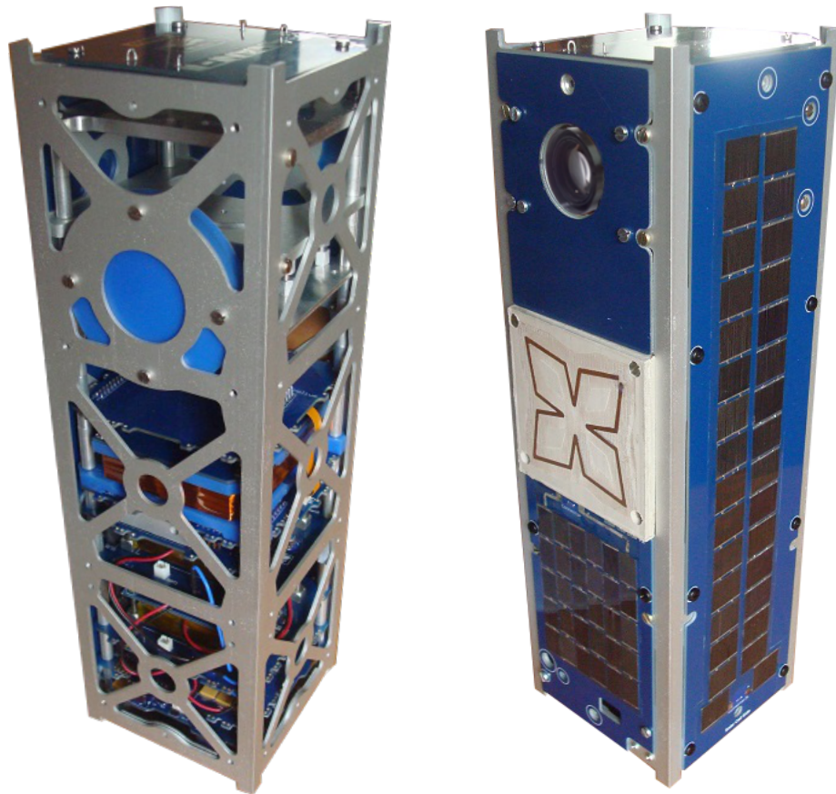
Figura 2.1: Estructura y ensamble final del satélite cubesat
