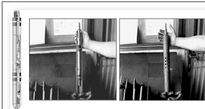
Figura 13. Válvula del sistema de bombeo neumático*
