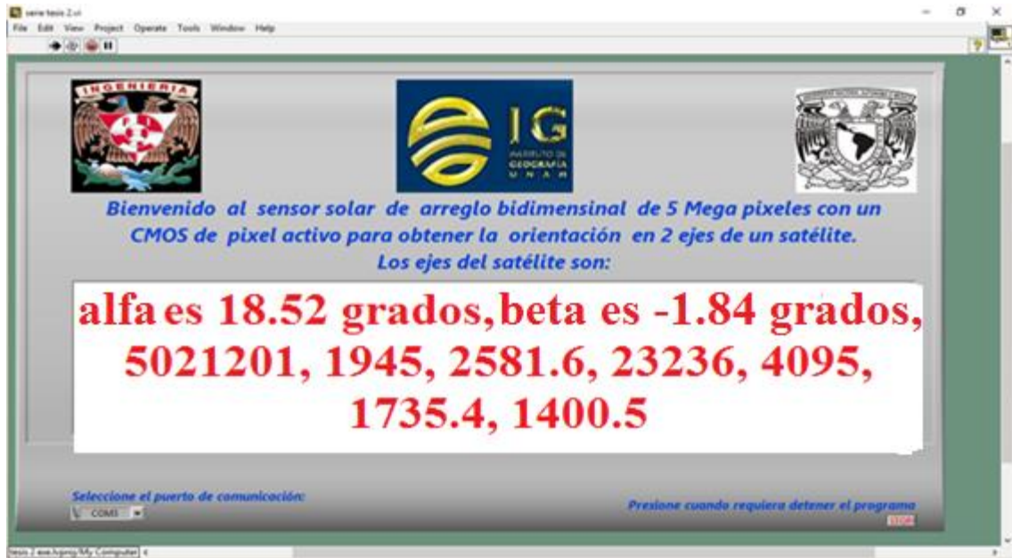
Figura 4.12.- Pantalla de visualización de los ángulos, diseñado en el programa LabView 2015 de 32 bits. Fuente: autoría propia.
