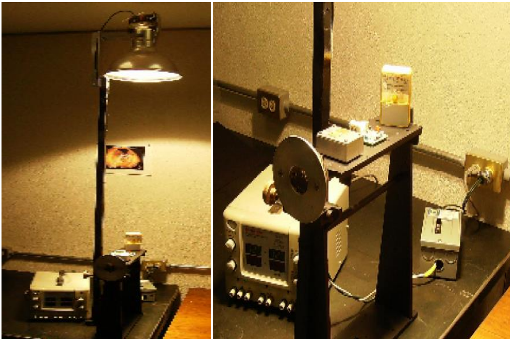
Figura 4.6. Simulador de sol del Instituto de Geografía de la UNAM. Sobre la platina móvil se muestra el sensor, la brújula electrónica y el medidor de potencia luminosa. Fuente: autoría propia y [1][2].
