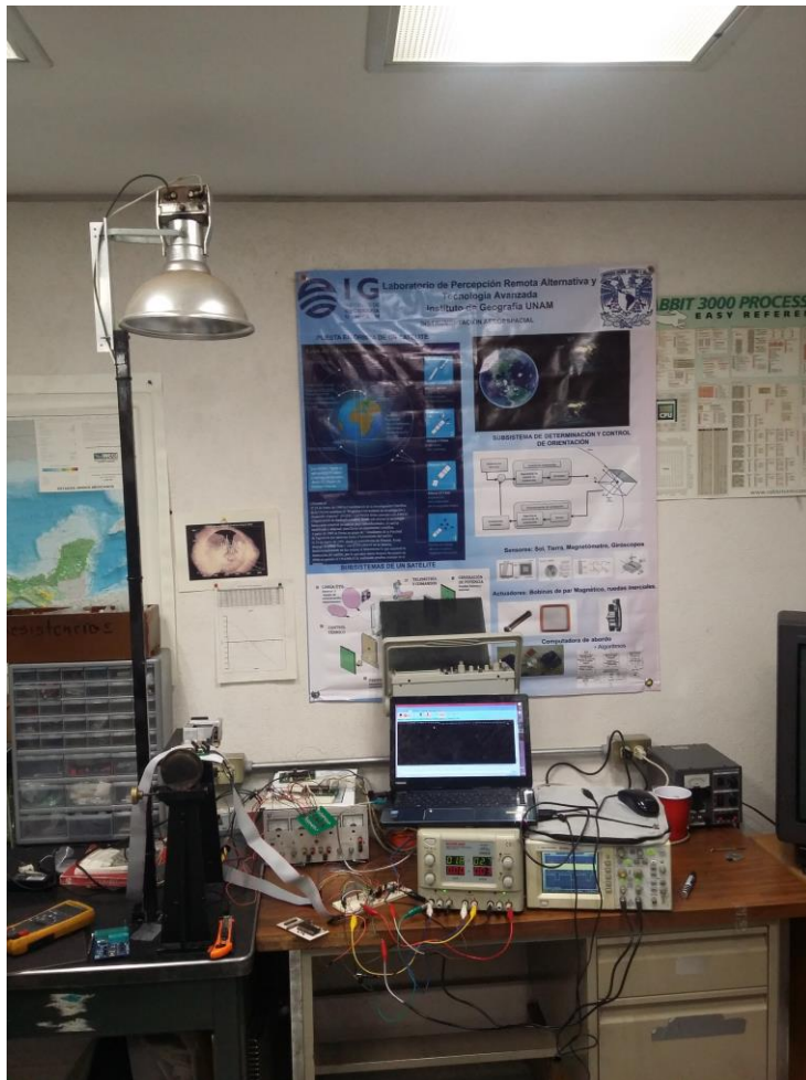
Figura 4.11.- Mediciones realizadas en el sensor solar con la lámpara que simula la radiación solar y los equipos de medición. Fuente: autoría propia y [1][2].
