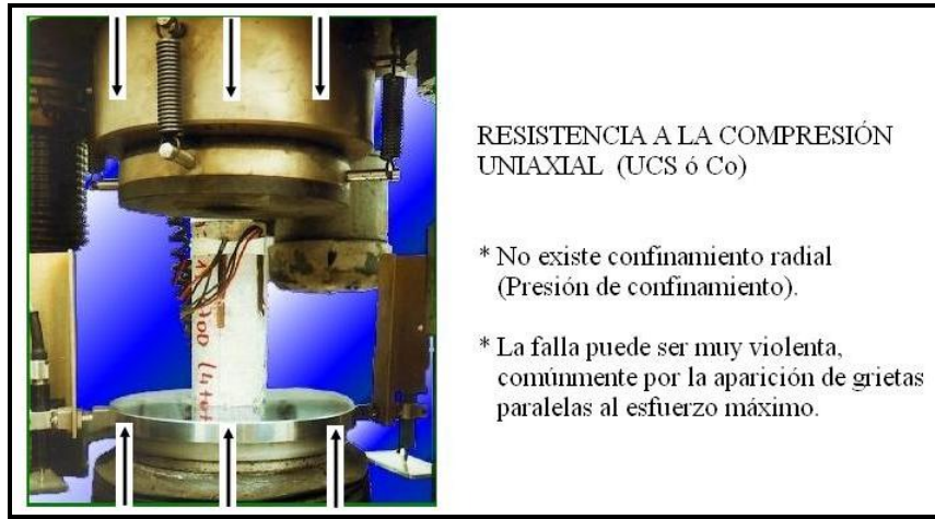
Figura 2.1 Prueba de laboratorio para encontrar la resistencia a la compresión uniaxial ( C_0 ).
