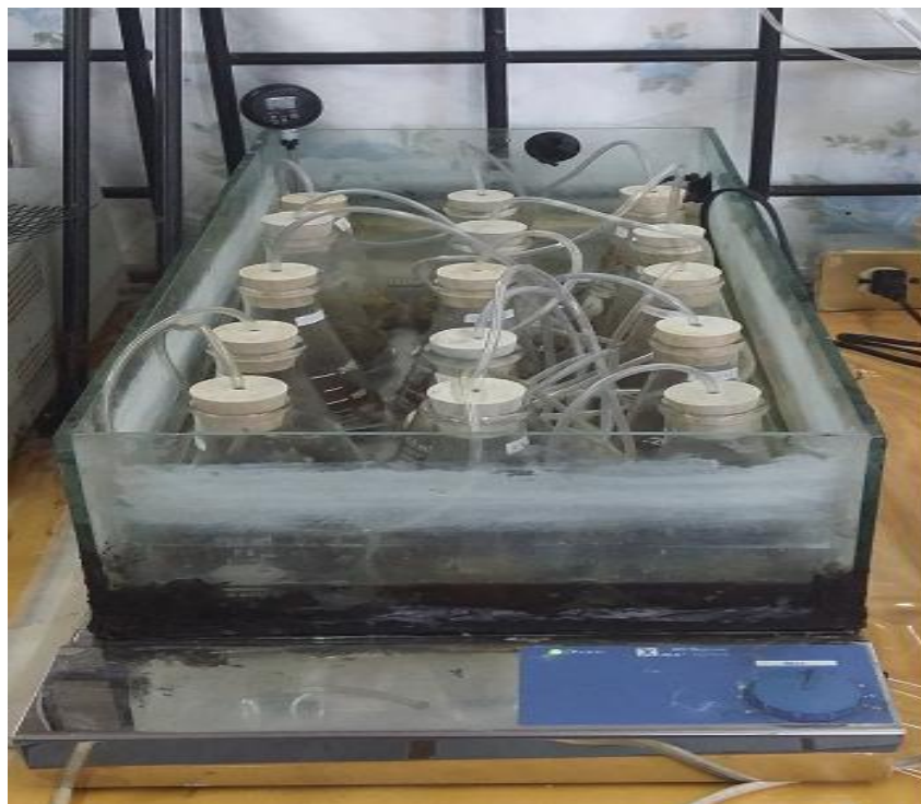
Figura 4.6 Montaje experimental para la producción de bioetanol.
