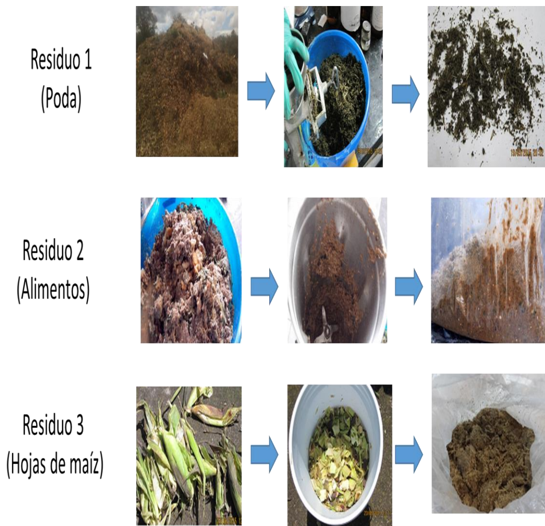
Figura 4.1 Proceso de trituración y molienda de los residuos.
