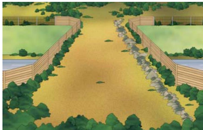
Fig. 4-19 Esquema general de un paso inferior específico para fauna (Ref. 7)
