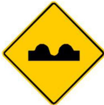
Fig. 5-14 Señal vertical preventiva SP-41, indica proximidad a los vibradores monolíticos. Ref. 15
