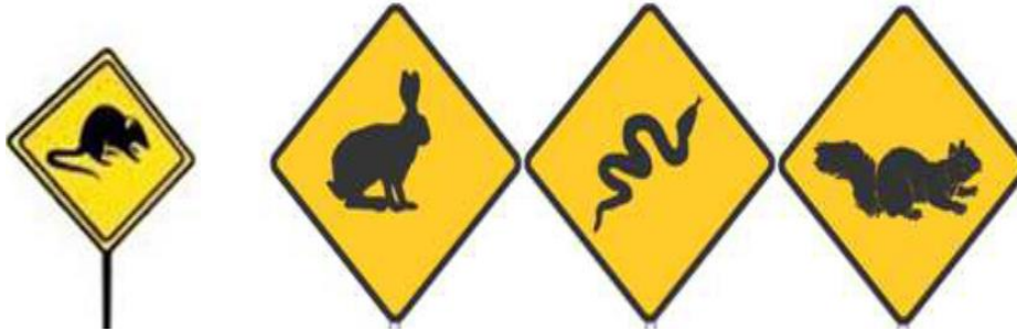
Fig. 5-15 Señalamiento preventivo acerca de la posibilidad de encontrar algunas especies en el tramo carretero. Ref. 15
