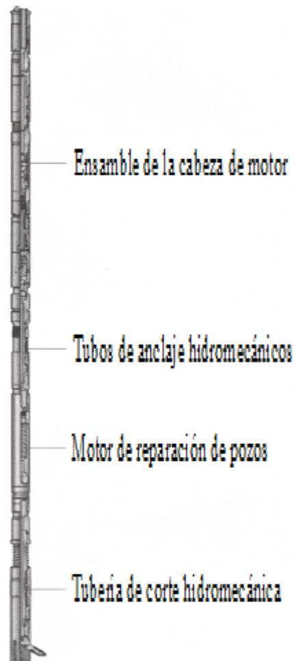
**Figura B.2** Sistema de tubería de corte hidromecánico
