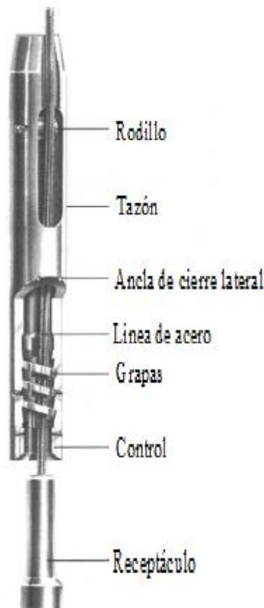
**Figura A.2** Pescante de cuñas de cierre lateral, permite que la línea entre en la herramienta.
