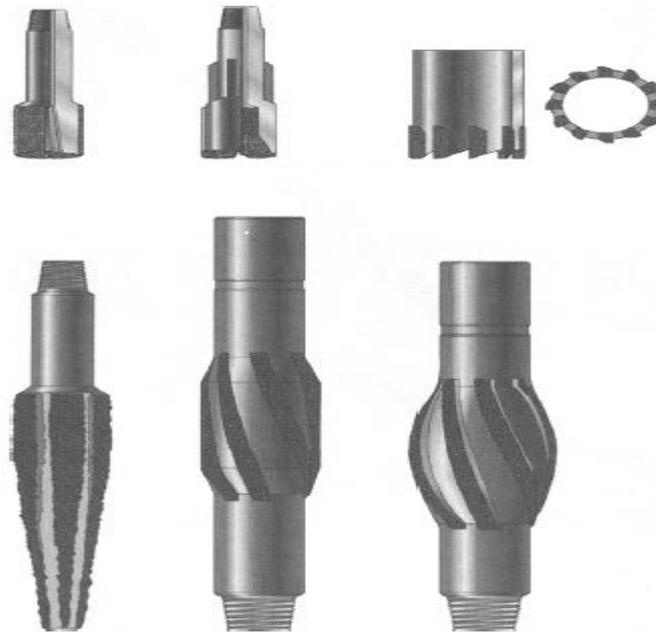
**Figura 3.12** Diferentes tipos de molinos y zapatas dentadas para cortar y moler.
