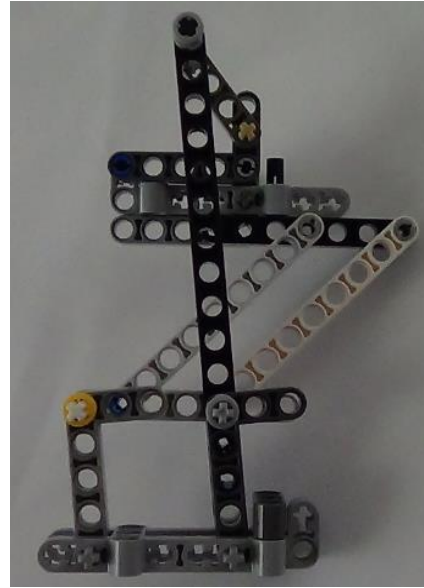
Ilustración 3.9 Prototipo rápido del mecanismo de las piernas.
