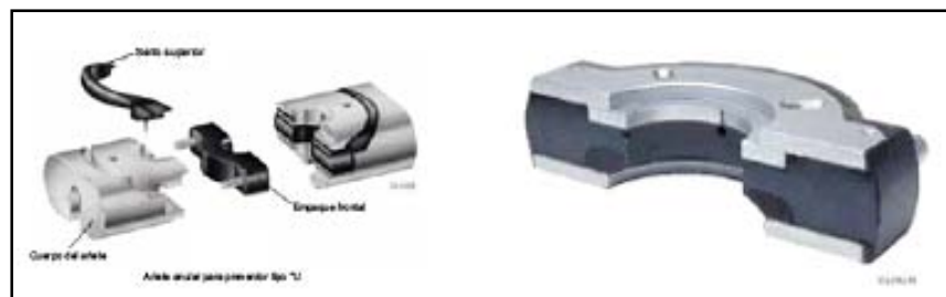
Figura 2-6. Ariete anular para preventor tipo “U”.
