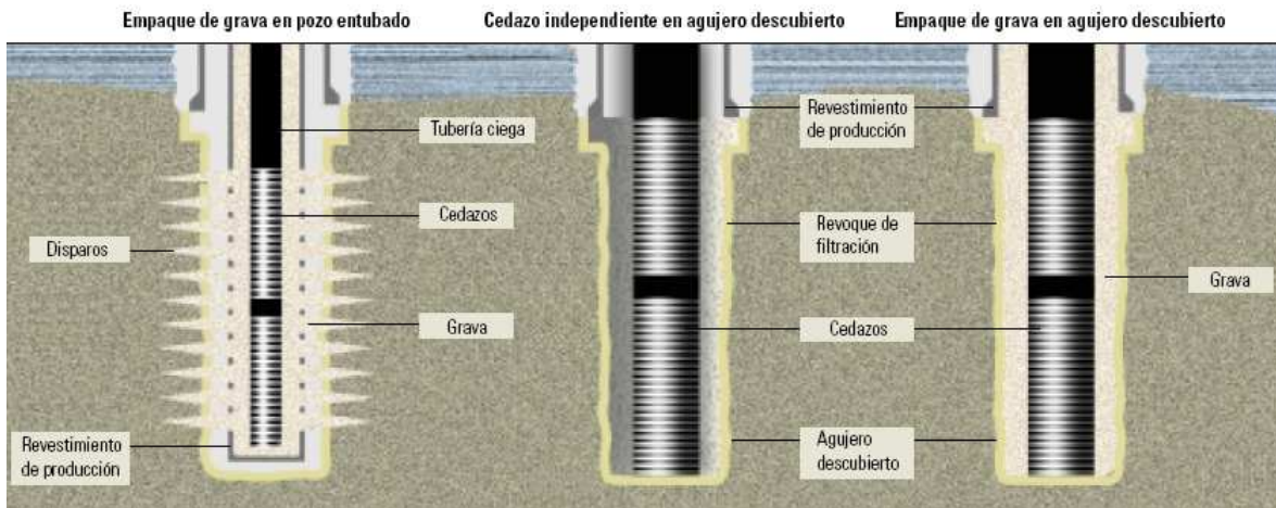
Figura 5.5 Empaques de grava en pozo entubado y en agujero descubierto, ( Oilfield review , 15, 1, 2004).
