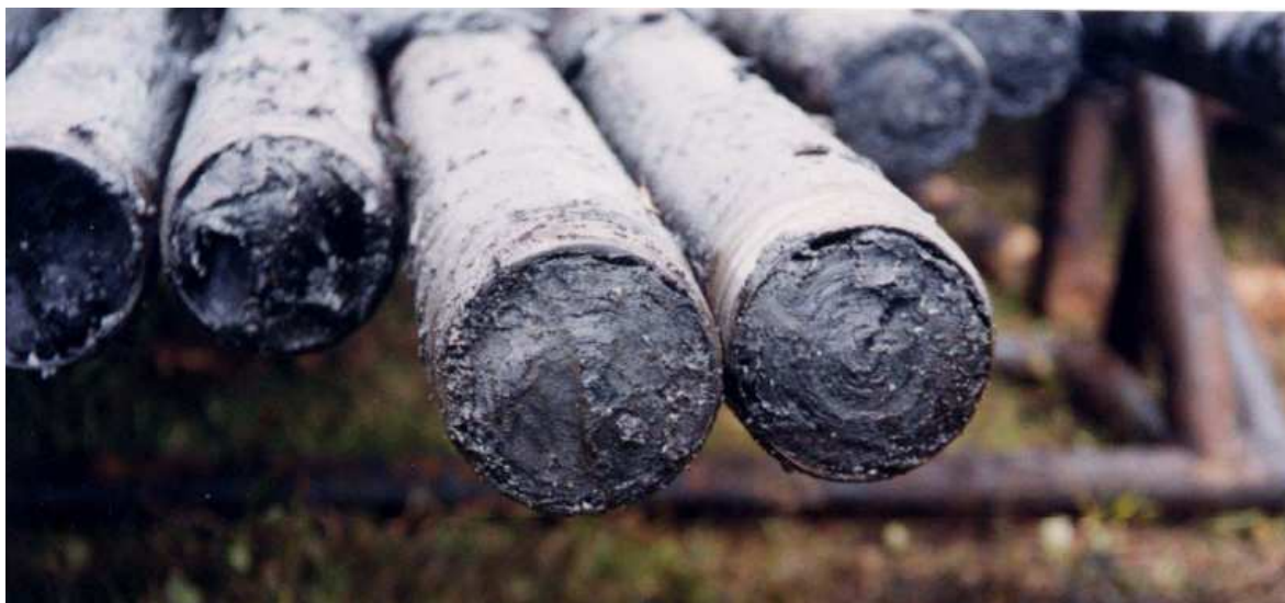
Figura 10.1 Tubería obstruida, (M-I SWACO 2009).
