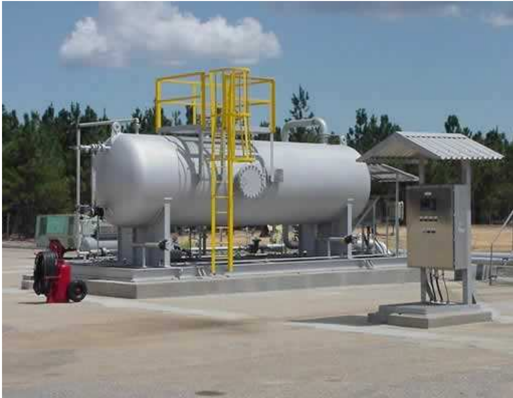
Figura 6.3 Separador bifásico horizontal (Francisco, R., 2000).
