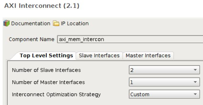
Figura 4.12: Configuración del bloque de interconexión de memoria RAM a bus AXI
