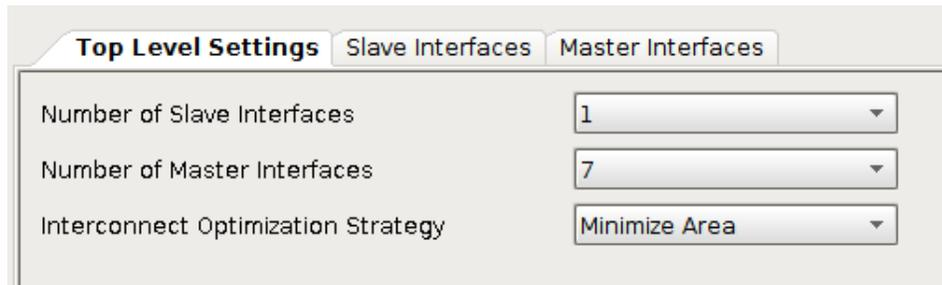
Figura 4.14: Configuración bus AXI del procesador con el resto de los periféricos
