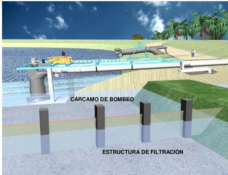
Dibujo 2.2. En este dibujo se observa el segundo filtro antes de llegar al cárcamo de bombeo
