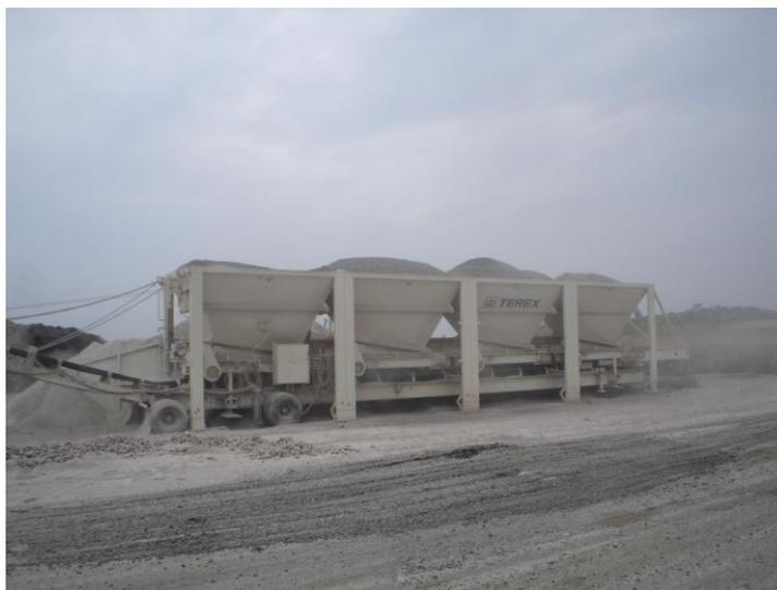
Estas tolvas de alimentación están dispuestas con compuertas ajustables para regular la caída del material, la granulometría se ajusta en la medida de las bandas transportadoras, los pesos de los agregados, los alimentadores pueden ser de banda o de vaivén, por lo que es posible dosificar los agregados para que caigan en el depósito con una primera granulometría controlada.
