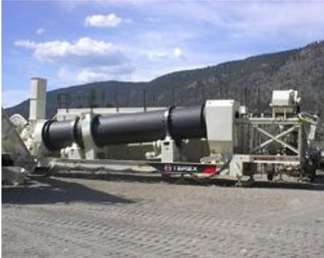
Este modelo es un mezclador único de tambor en contracorriente completo, con un sistema de control de contaminación instalado para reducir emisiones contaminantes.
