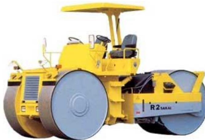
2. Inmediatamente después, se inicia la vibración de 2400 r.p.m. en baja amplitud. Aquí es muy importante determinar la velocidad lineal del compactador. Debe ser tal que no provoque grietas no bordes, o sea, ni tan despacio que estemos aplicando demasiados golpes muy cercanos unos a otros, ni tan deprisa que espaciemos demasiado la aplicación de la fuerza provocando grietas.
