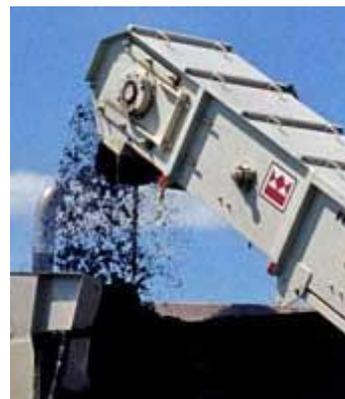
Cuando se usa una fresadora para extraer pavimento asfáltico el tamaño de los materiales fresados oscila de 50 a 100 mm.
