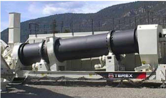
Cerca del extremo de la descarga del tambor, el cemento asfáltico es rociado sobre los agregados. Los controles automáticos supervisan la cantidad agregada y la miden en la proporción apropiada de cemento asfáltico. Durante la rotación del tambor, los vuelos o paletas producen en el tambor una acción que se mezcla entre
