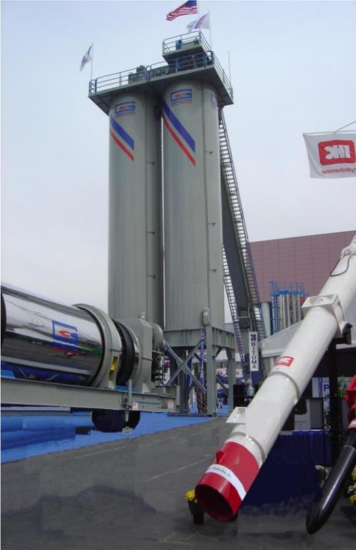
Estos silos permiten a la planta funcionar independiente de la disponibilidad inmediata del camión. Esto es particularmente favorable cuando la planta realiza trabajos en porciones con diversos diseños de la mezcla. Los silos también permiten al operador de planta premezclar y almacenar varias producciones del concreto asfáltico para acomodar una distribución desigual de las llegadas del camión en la planta.
