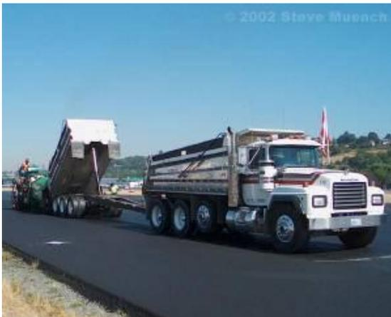
Los camiones de descarga del extremo descargan su contenido levantando el extremo delantero de la caja y dejando la carga útil resbalar abajo del fondo de la base y hacia fuera de la parte posterior a través de una puerta trasera.
