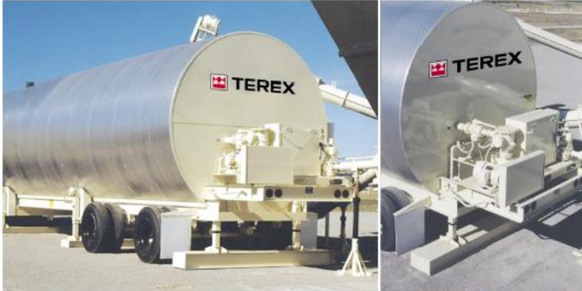
En un sistema de aceite caliente, primero se calienta el aceite de la transferencia, y entonces el aceite calentado se circula con la instalación de tubos dentro del tanque del asfalto.
