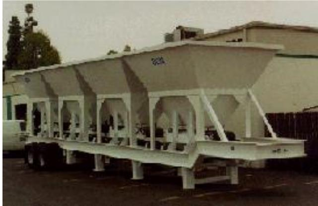
En el fondo de cada compartimiento está una puerta para controlar el flujo material y una unidad del alimentador para medir el flujo. El operador de la planta ajusta el flujo de agregados de cada compartimiento para asegurar un suficiente flujo del material para mantener una carga adecuada de agregados a los compartimientos calientes.
