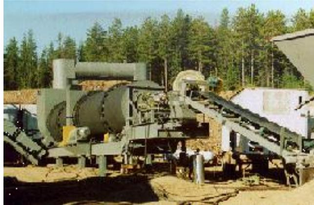
Por lo tanto, el agregado debe ser calentado lo suficientemente al paso de los procesos para producir una buena mezcla final a la temperatura deseada. Los agregados se introducen en el extremo del secador a través del tambor opuestamente al flujo del gas.
