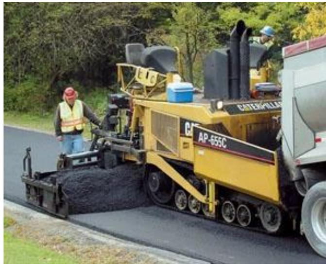
A cada lado de la plancha maestra tiene un largo brazo que conecta la unidad tractiva con un centro pivote. Este mecanismo le permite, a la plancha maestra flotar sobre la mezcla mientras esta se tiende. La plancha, al recibir la mezcla que reparten los tornillos, la extiende con el nivel, el ancho y la profundidad proporcionados por los controles y le aplica una compactación inicial al material asfáltico mediante una barra o vibradores.
