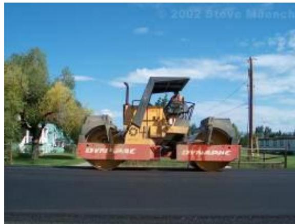
Esto proporciona la posibilidad de efectuar las tres fases de compactación en una sola. Cada mezcla es, en algo, única y diferente a las demás, por lo que es necesario determinar en cada caso la forma o patrón de compactación, mediante vibradores. Estos pueden ser de un tambor liso metálico propulsado por llantas neumáticas o de dos tambores o rodillos con tracción en ambos.
