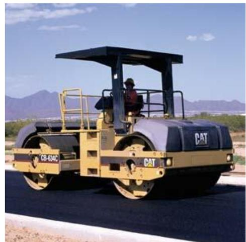
Por lo general se realizan dos pasadas a todo lo ancho y otra en alta amplitud para obtener el grado de compactación deseado; con esto es suficiente.
