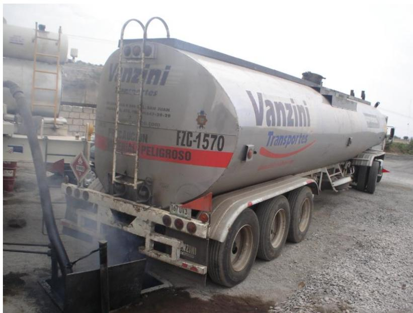
Un calentador de fuego directo consiste en una parrilla colocada en un tubo en el tanque de almacenamiento del asfalto. Con estos sistemas, el asfalto se debe mantener siempre la suficiente fluidez para sumergir el tubo de la parrilla. Estos sistemas tienen una eficacia térmica más alta que el proceso del aceite caliente.
