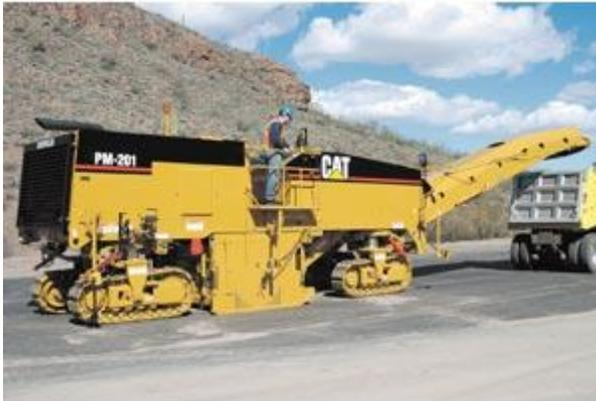
Este modelo combina capacidades realzadas de la producción, funcionamiento optimizado y servicio simplificado para terminar trituraciones resistentes con resultados productivos. El motor es confiable, diseñado para la alta producción y duradero, el rotor PM-102 tiene sostenedores de herramienta cónicos del lanzamiento rápido para el reemplazo rápido y fácil de la herramienta. Y el transportador se puede doblar para reducir dimensiones de la máquina durante transporte.
