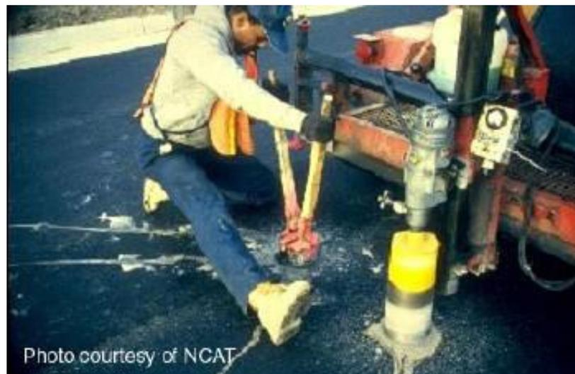
2. *Densímetros nucleares*. Una galga nuclear de densidad mide la densidad sobre el terreno de el asfalto usando la radiación gamma. Las galgas contienen generalmente una fuente gamma pequeña (MCI cerca de 10) por ejemplo Cesium-137 situado en el extremo de una punta de prueba pequeña, que se pone en la superficie del pavimento o se inserta en el pavimento.
