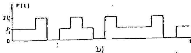
FIGURA 11. Transmisión de un código bipolar usando tres niveles de potencia óptica.
