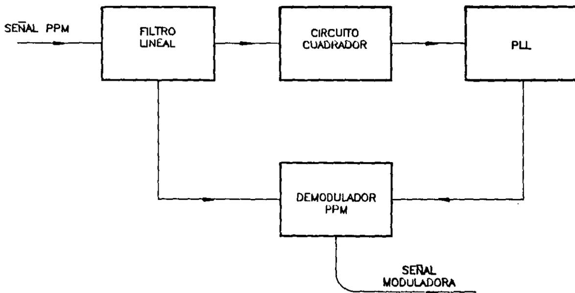
Fig. 11.- Demodulación PPM
