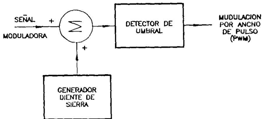
Fig. 3.- Generación de Modulación PWM con muestreo no-uniforme.
