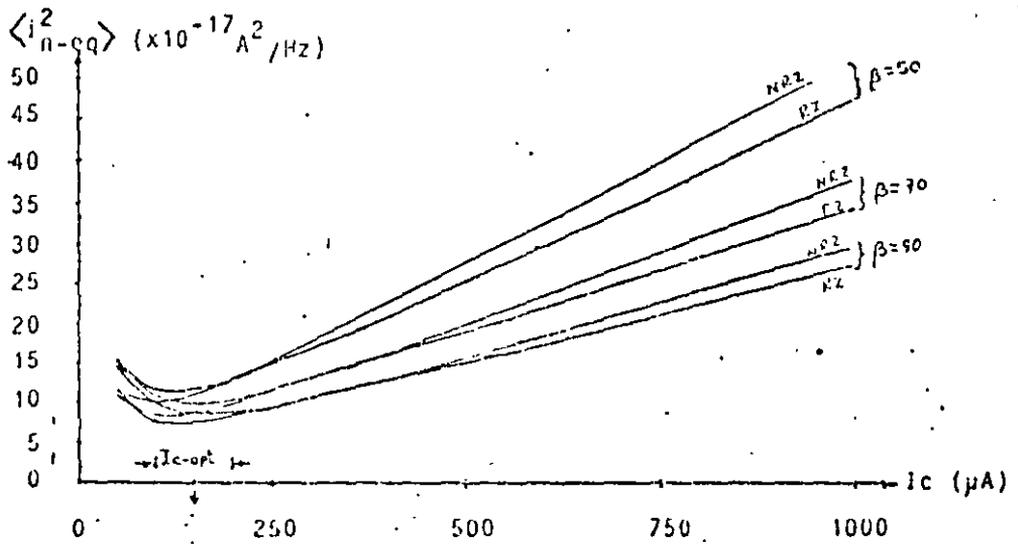
Fig. 3.4.-Comportamiento de la corriente de colector de  $T_1$  contra el valor cuadrático medio de la corriente de ruido equivalente de entrada, para diferentes  $\beta$  y los formatos RZ y NRZ
