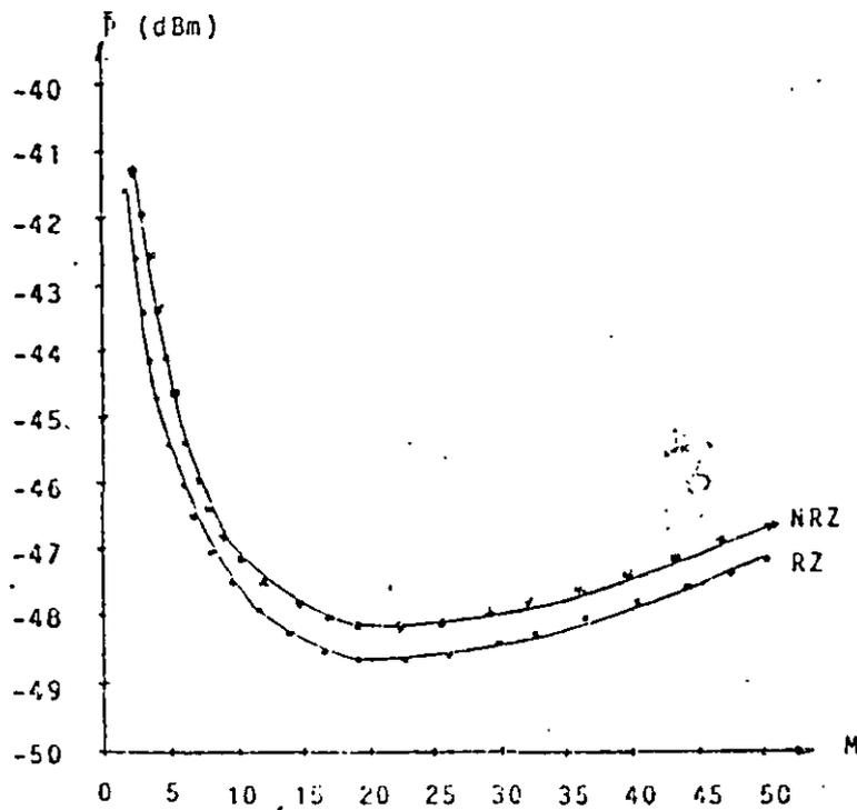
Fig.3.5.-Sensibilidad del preamplificador contra ganancia del APD.
