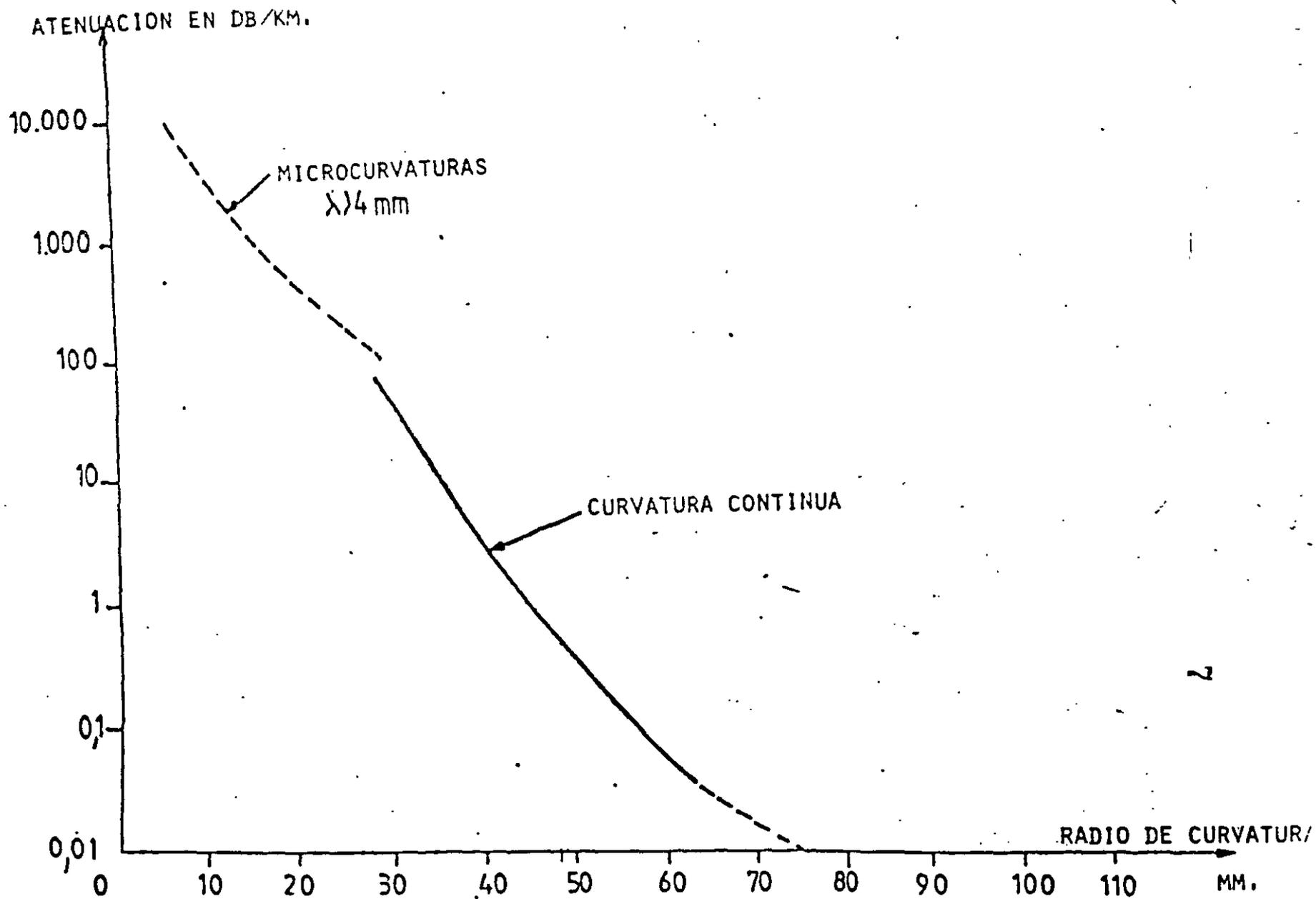
FIGURA 5.-2.- ATENUACION EN EXCESO EN FUNCION DEL RADIO DE CURVATURA
