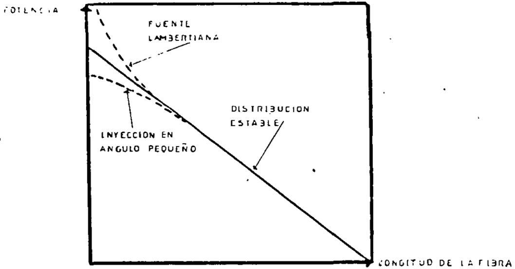
FIG 2 CURVA TIPICA DE ATENUACION DE POTENCIA CON LA DISTANCIA PARA LAS DISTRIBUCIONES DE POTENCIA DE LA FIG. 5.1
