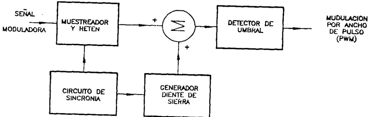
Fig. 2.- Generación de Modulación.
