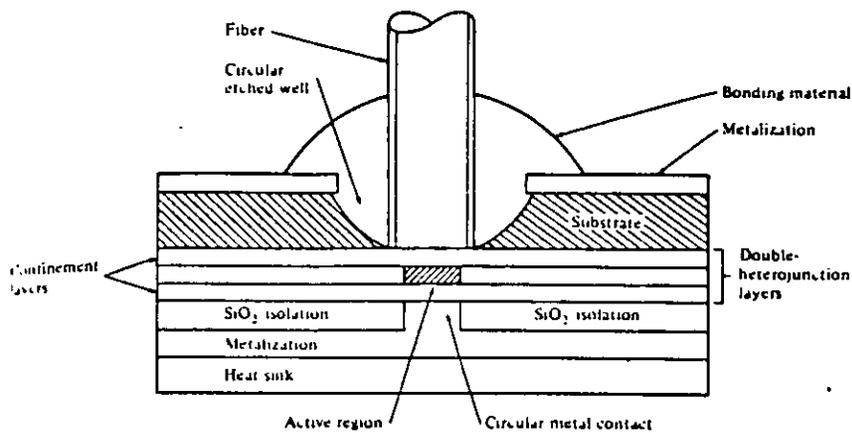
Fig. 5 Diodo emisor de superficie
