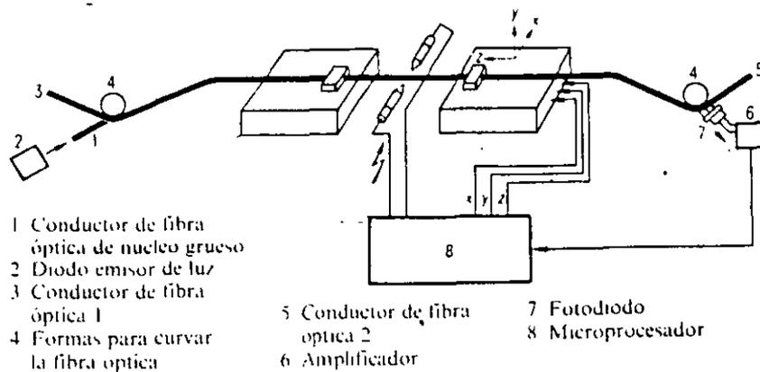
Fig. 7.16 Alineamiento automático de la fibra usando microprocesador y sistema LID.
