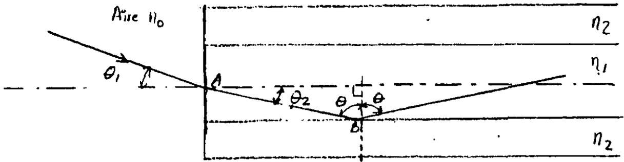
Fig. 7.- Trayectoria de un rayo meridional acoplado a una fibra óptica con un ángulo menor al ángulo de aceptación de la fibra.
