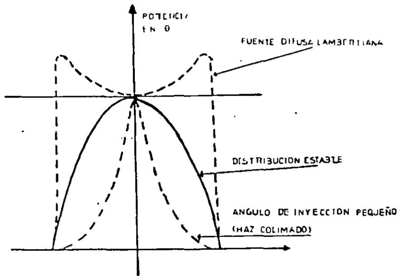
FIG 1 DISTRIBUCIONES DE POTENCIA TIPICA EN UNA FIBRA DE INDICE DE ESCALON PARA SITUACIONES DIVERSAS
