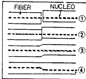
FIG. 7.17 EFECTO NEGATIVO DE LA TENSION SUPERFICIAL
