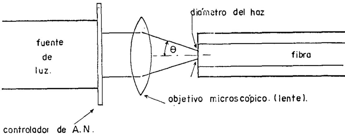
FIG.5 ARREGLO PARA LA TECNICA DE HAZ PUNTUAL.
