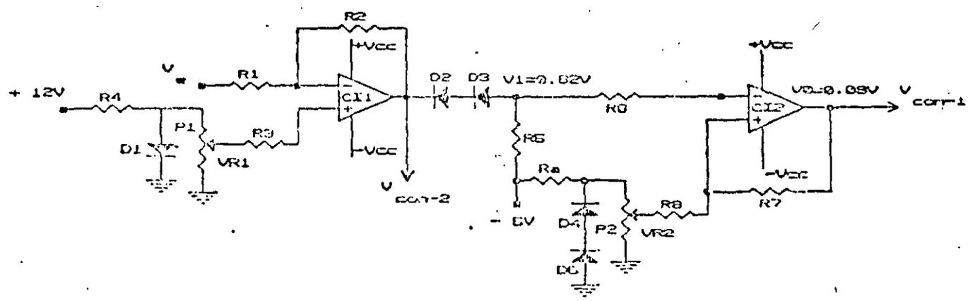
Fig.3.15.-Red de retroalimentación para el control automático de ganancia del receptor óptico
