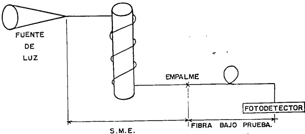
FIG.6 SIMULADOR DE MODOS EQUILIBRADOS TIPO FIBRA ENROLLADA.
