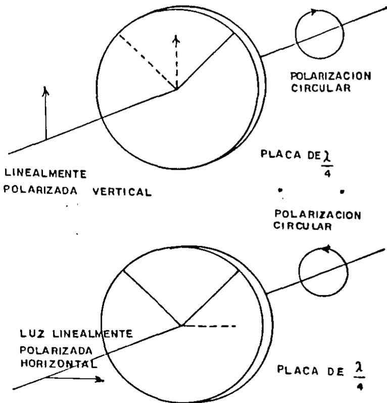
FIG. 7 PLACA DE UN CUARTO DE LONGITUD DE ONDA.
