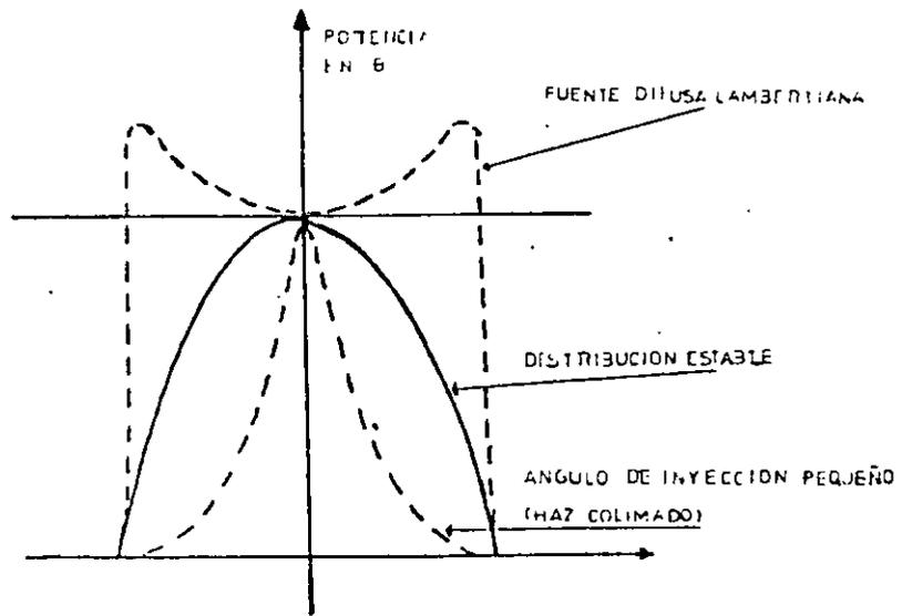
FIG 1 DISTRIBUCIONES DE POTENCIA TÍPICA EN UNA FIBRA DE ÍNDICE DE ESCALON PARA SITUACIONES DIVERSAS
