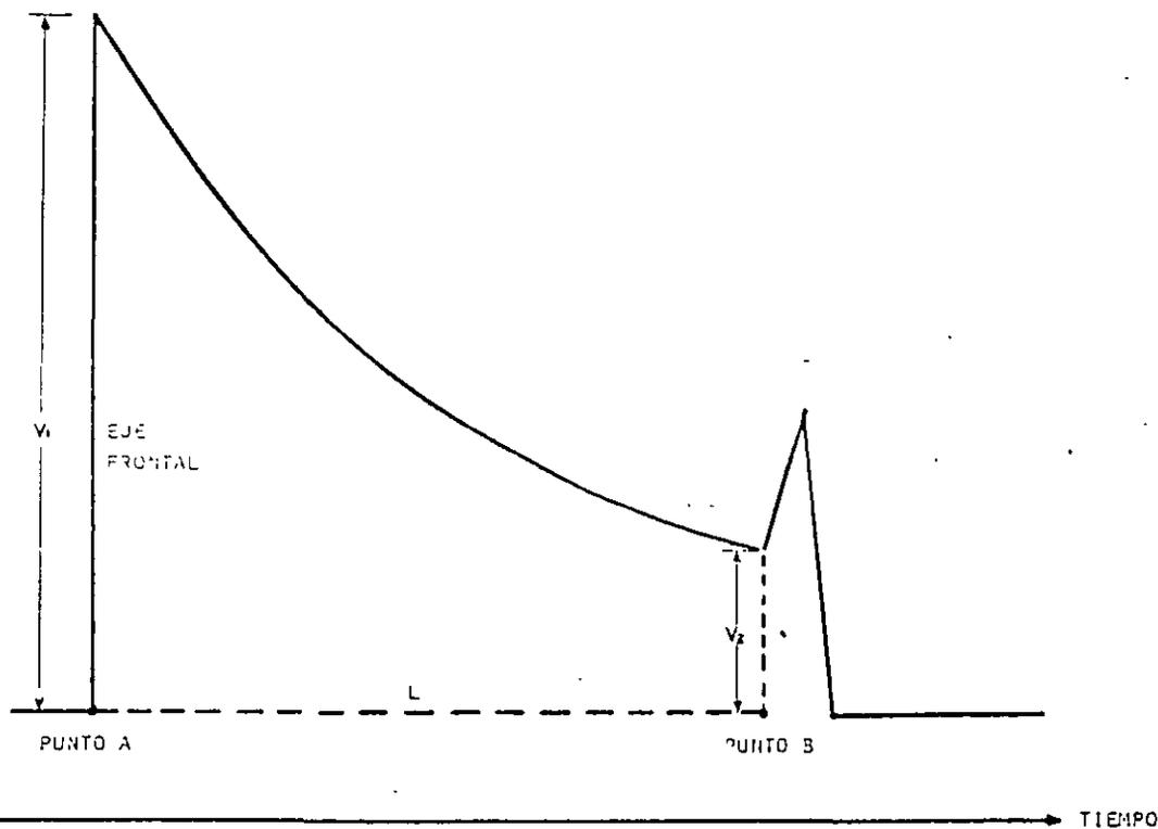
FIG. 15 MEDICION DE LONGITUD EN UNA FIBRA
