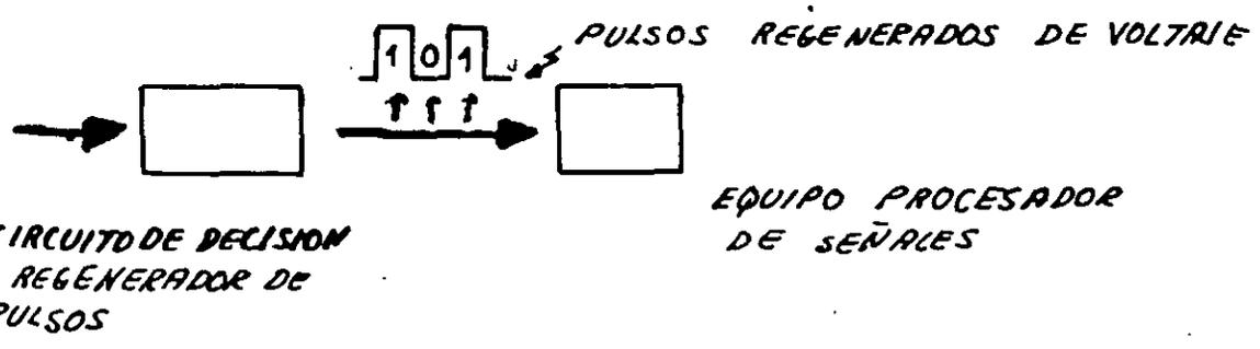
FIG. TRAYECTORIA DE LA SEÑAL A TRAVES DE UN SISTEMA OPTICO DE COMUNICACIONES DE SEÑALES
