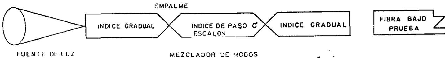
**FIGURA 9 - MEZCLADOR DE MODOS DE PERDIDA BAJA FORMADO POR DOS TRAMOS DE FIBRA DE INDICE GRADUAL Y UN TRAMO DE INDICE DE PASO**
