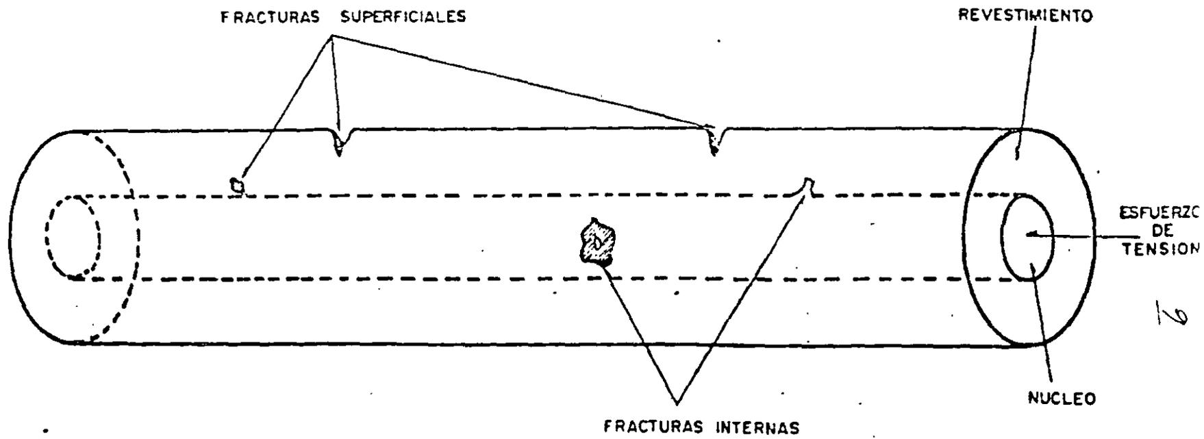
FIGURA 5.-3.- MICROFRACTURAS EN LA FIBRA OPTICA
