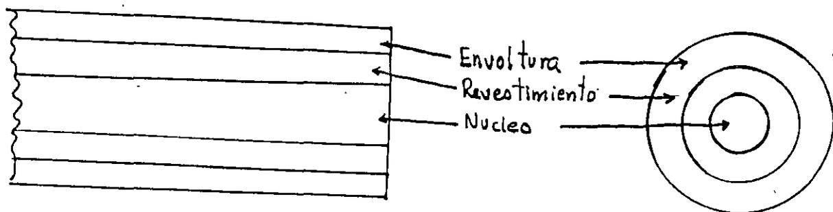
Fig. 1.- Estructura física de una fibra óptica.
