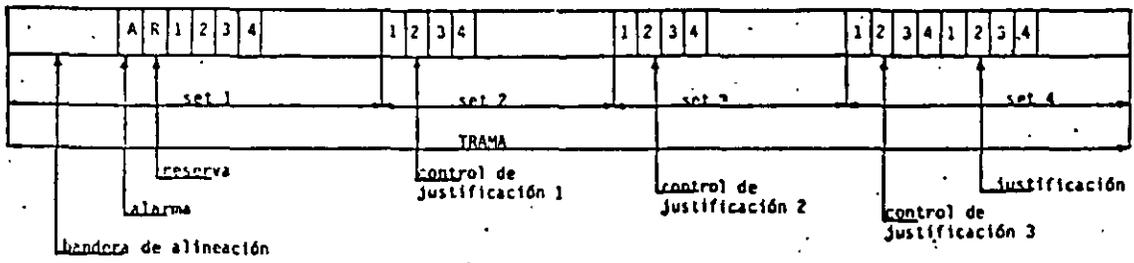
Figura 11. Estructura de trama de segundo nivel (3.440 kb/s)
