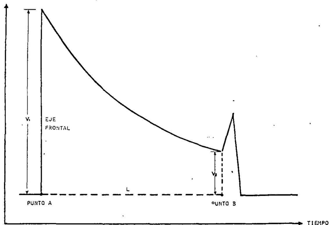
FIG. 15 MEDICION DE LONGITUD EN UNA FIBRA
