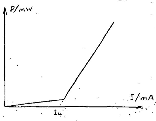
FIGURA 12 Respuesta de un diodo láser.
