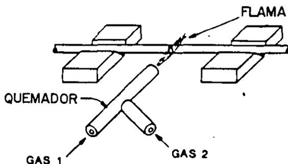
**FIG. 7.12 FUSION DE LA FIBRA POR MICROFLAMA**
