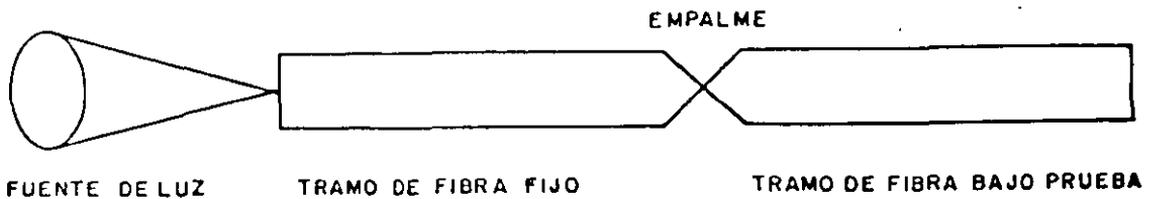
**FIGURA 4.- OBTENCION DE DISTRIBUCION DE POTENCIA ESTABLE USANDO UN TRAMO DE FIBRA FIJO.**
