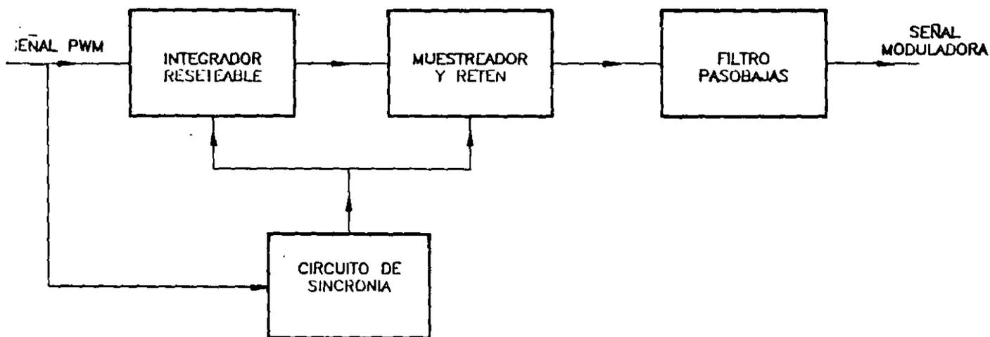
Fig. 4.- Demodulación PWM
