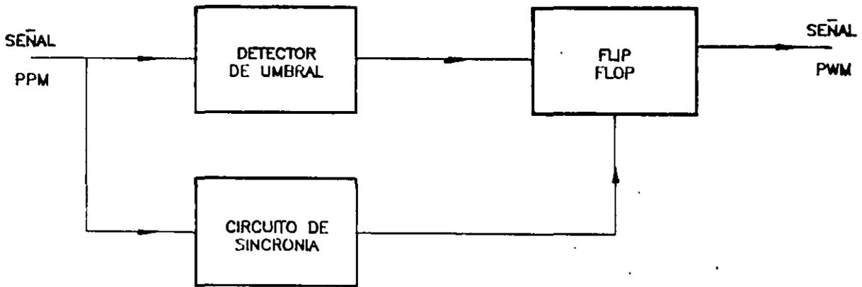
Fig. 12.- Diagrama a bloques de un demodulador PPM.
