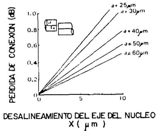
FIG. 7.1 PERDIDA POR DESALINEAMIENTO DEL EJE DEL NUCLEO GI
