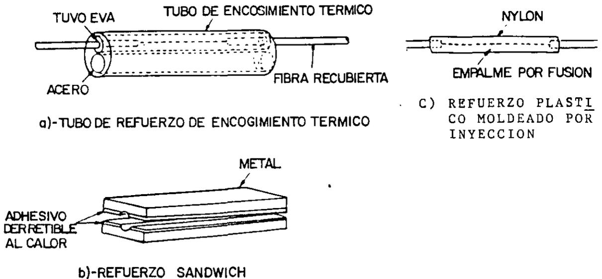
Fig. 7.21 Diferentes estructuras de protector de empalme.
