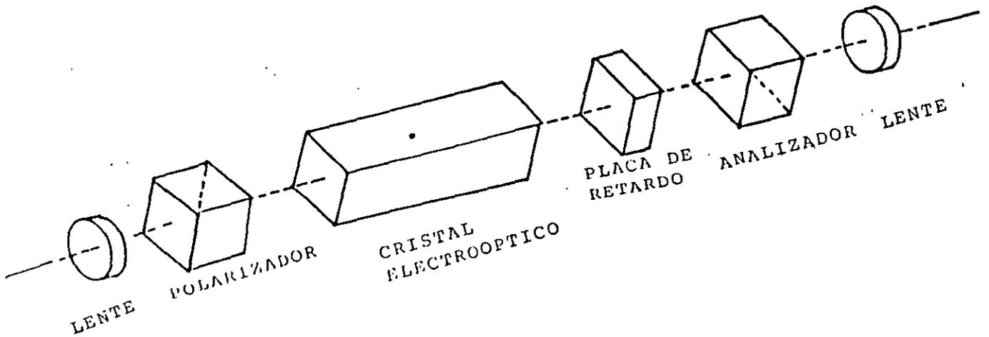
fig. 4.2 Los componentes del modulador electroóptico.
