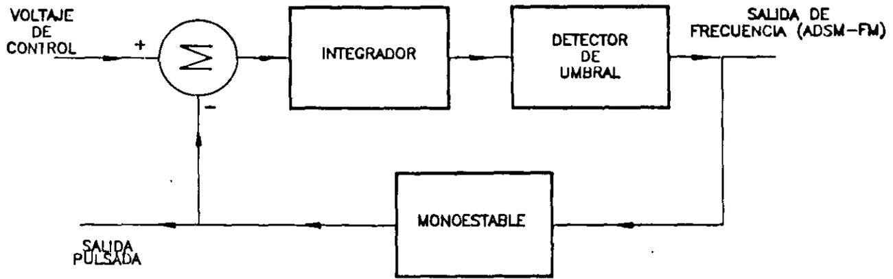
Fig. 5.- Generación de Modulación ADSM-FM
