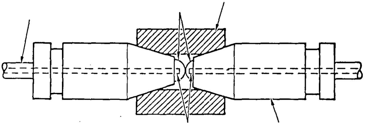
Fig. 3b. Corte transversal de una pareja de conectores bicónicos
