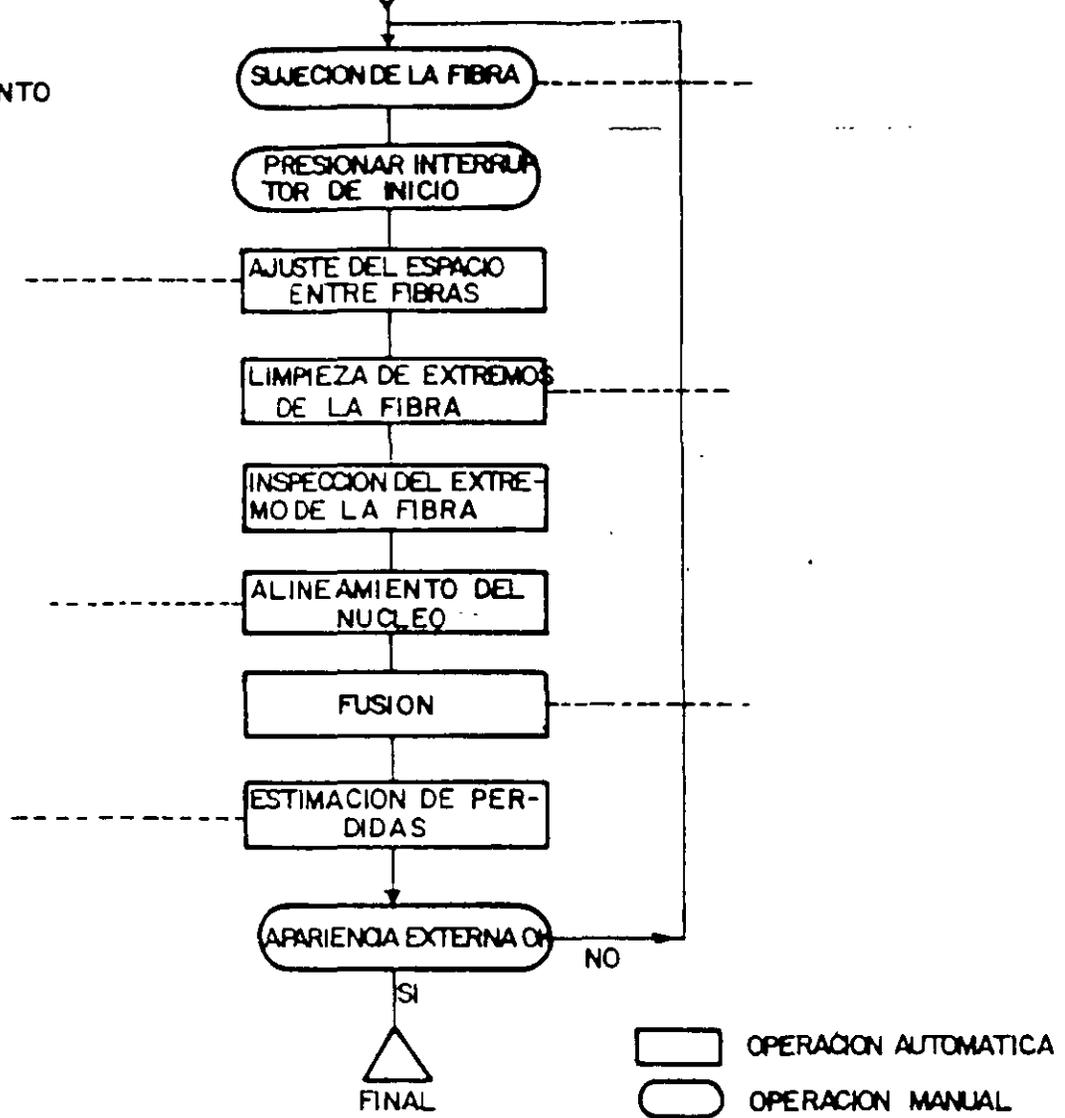
Fig. 7.19 Fusión automática de una fibra con la empalmadora Sumitomo 35.
