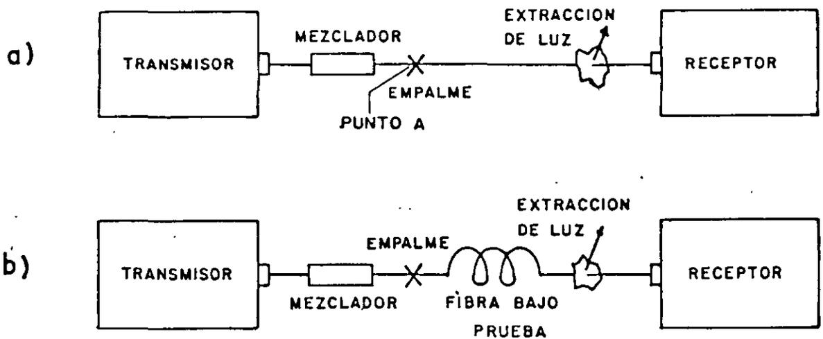
**FIG. 10.- MEDICION DE ATENUACION POR EL METODO DE PERDIDA DE INSERCIÓN a) PARA EXTREMO CERCANO
