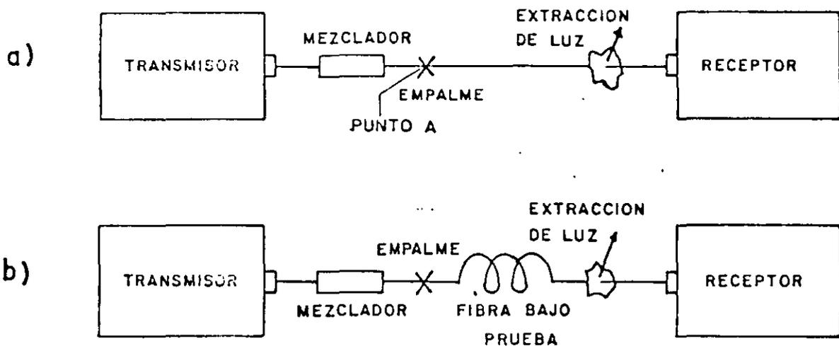
**FIG. 10.- MEDICION DE ATENUACION POR EL METODO DE PERDIDA DE INSERCIÓN a) PARA EXTREMO CERCANO b) PARA EXTREMO LEJANO**
