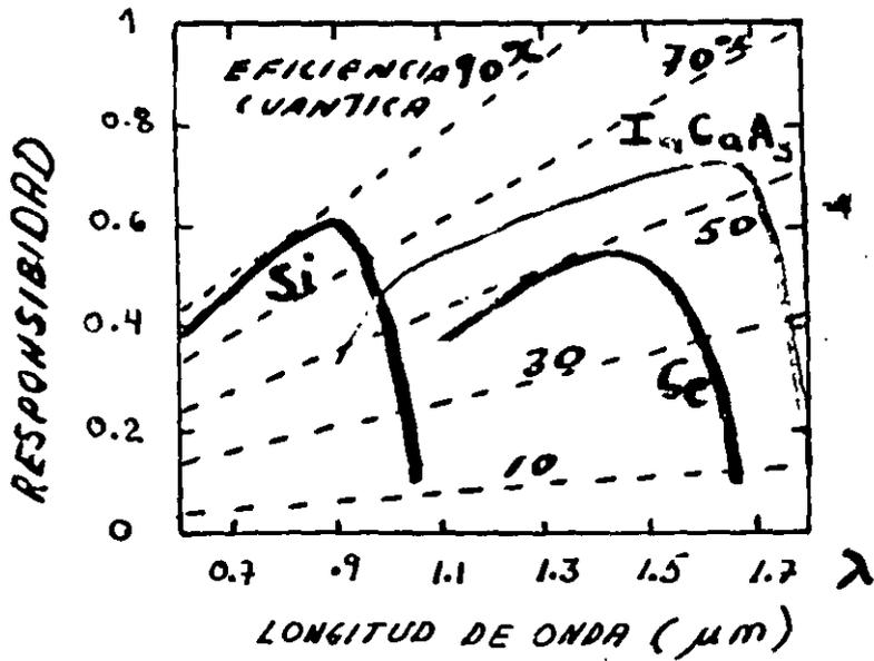
FIG COMPARACION DE LA RESPONSABILIDAD Y EFICIENCIA CUANTICA COMO FUNCION DE  $\lambda$ , DE FOTODIODOS PIN DE DIFERENTES MATERIALES
