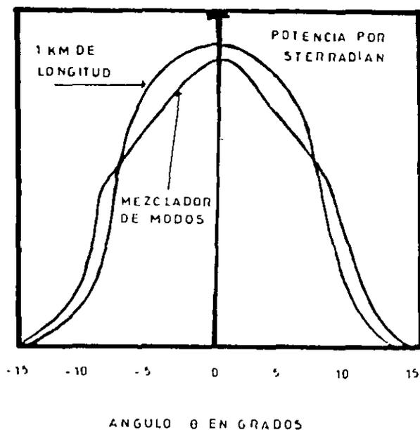
FIG. 3 DISTRIBUCIONES DE POTENCIA EN UNA FIBRA
