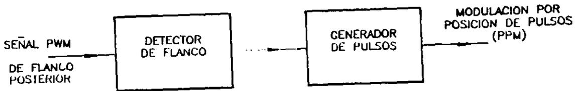
Fig. 10.- Generación de Modulación PPM
