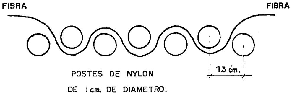
FIG.7 SIMULADOR DE MODOS EQUILIBRADOS TIPO FIBRA EN SERPENTINA.
