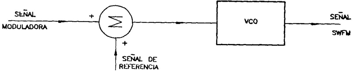
Fig. 8.- Generación de Modulación SWFM
