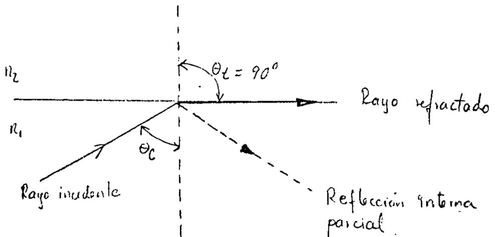
Fig. 3.- Caso límite de refracción que muestra el rayo de incidencia en el ángulo crítico  $\theta_c$ .
