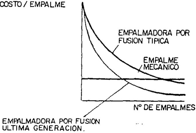
Fig. 7.26 Costo por empalme para método mecánico por fusión.
