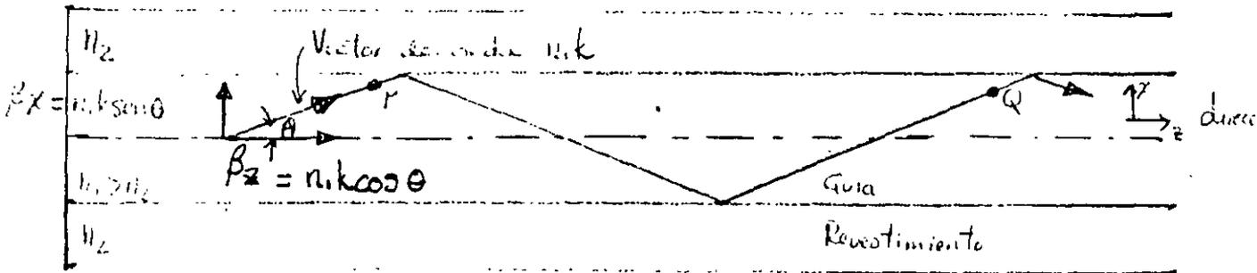
Figura 9.- Propagación de una onda plana en una guía. El vector de onda corresponde a un rayo equivalente.
