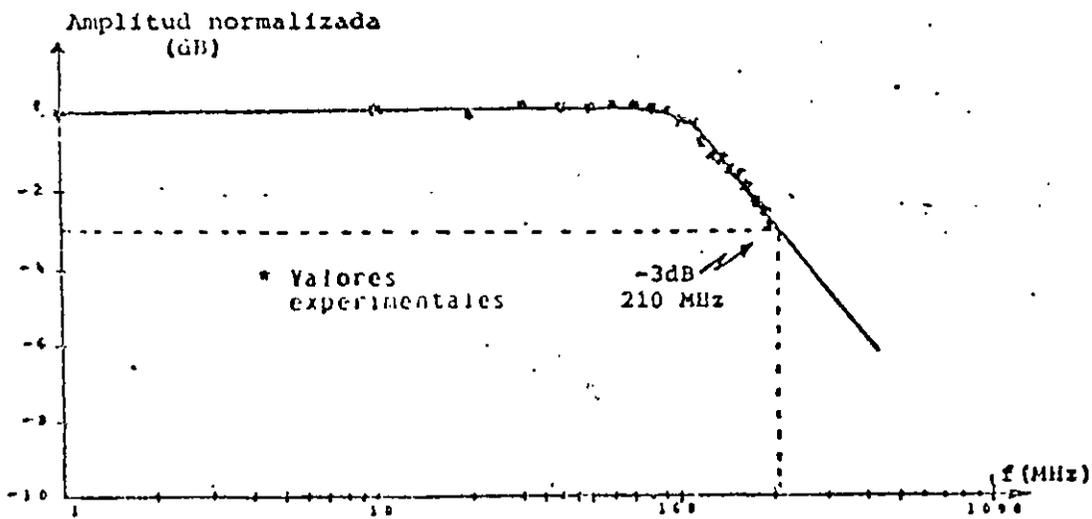
Fig.4.17.-Característica amplitud frecuencia del bloque de RF
