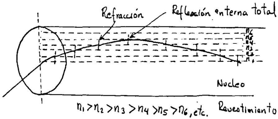
Figura 13.- Diagrama que muestra la refracción en las diversas interfaces de alto a bajo índice en una fibra de índice gradual lo que da una trayectoria curva del rayo.
