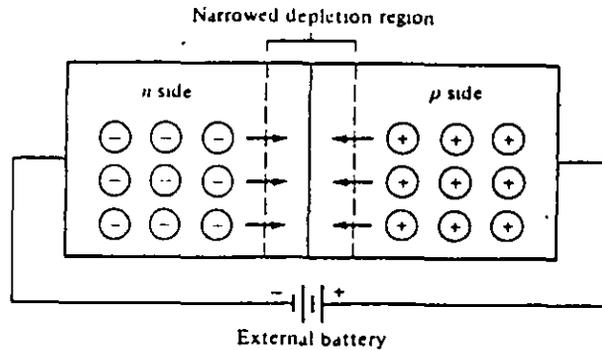
Fig. 3 Unión PN polarizada directamente
