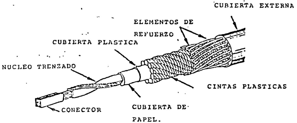
FIG. 5.-6 Cable Óptico que contiene 144 fibras
