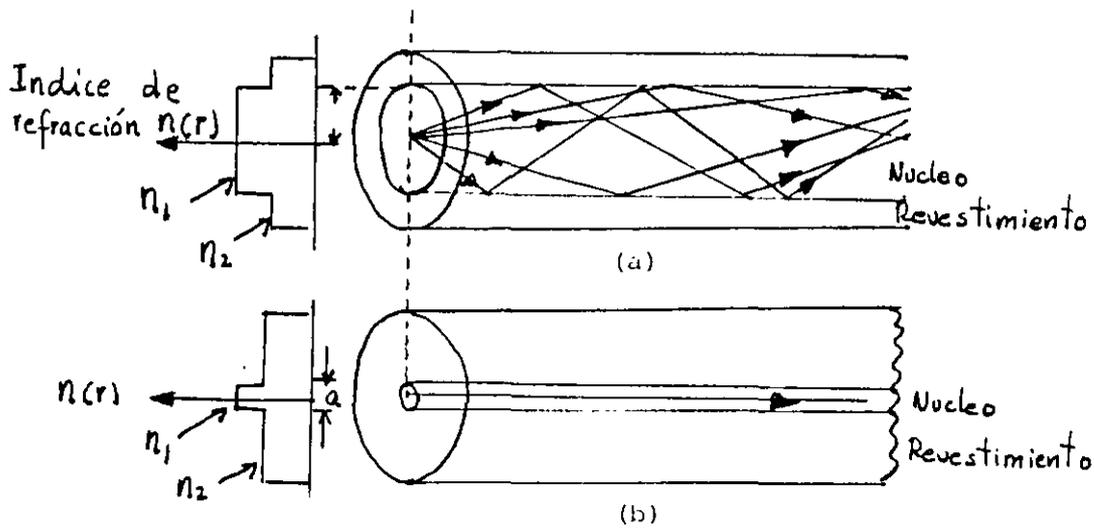
Fig. 11.- Perfil de índice de refracción y transmisión de rayos para fibras de índice escalonado (a) fibra de índice escalonado multimodo y (b) fibra de índice escalonado unimodo.
