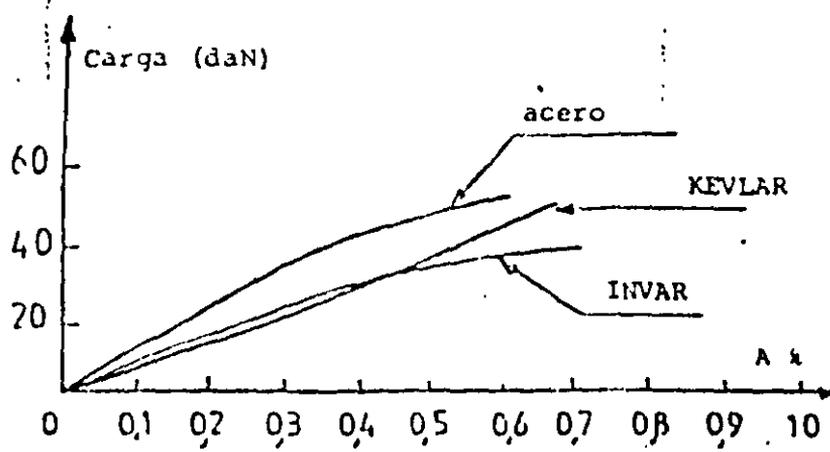
Fig. 5<sub>r</sub>-13 Prueba de tensión para el elemento de refuerzo de la estructura cilíndrica ranurada.
