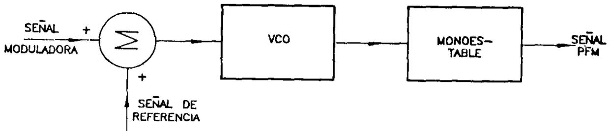
Fig. 6.- Generación de Modulación PFM
