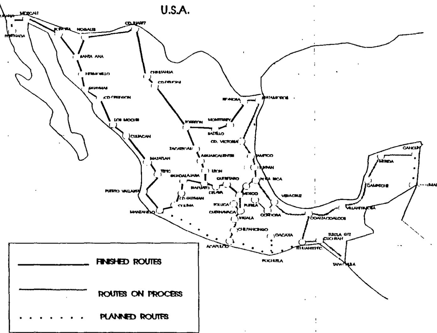
FIG. 1 TELMEX NATIONAL FIBER OPTIC BACKBONE
