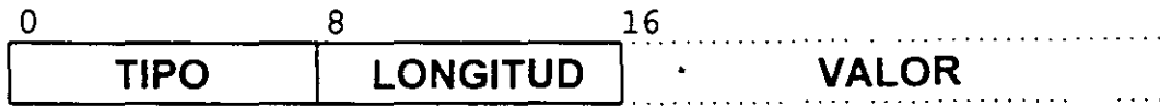
Figura 29.9 Codificación de una opción individual en el encabezado de la extensión opcional IPv6. Cada opción consiste en un tipo de un octeto y una longitud de un octeto seguidos por cero o más octetos de datos para la opción.
