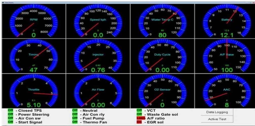
**Figura V.61 Ventana de monitoreo de sensores.**
