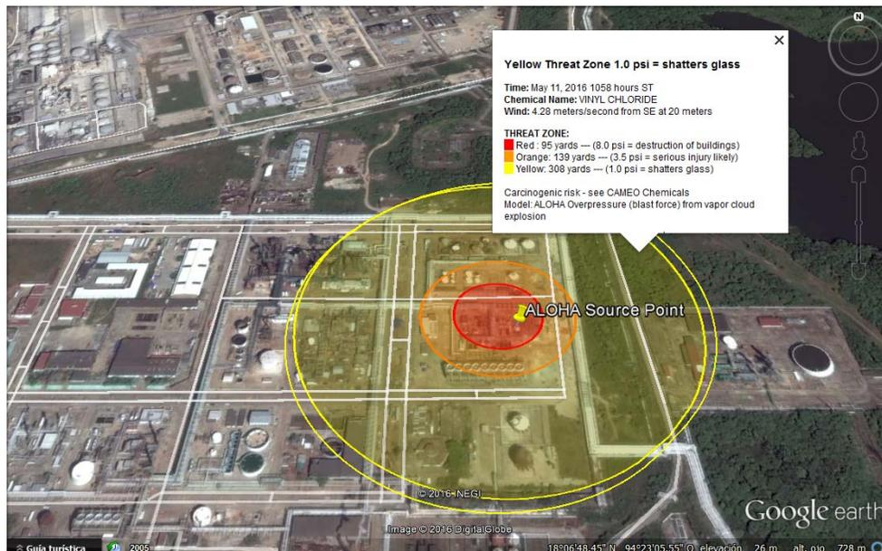
Figura 23 Simulación de explosión de esfera de almacenamiento
