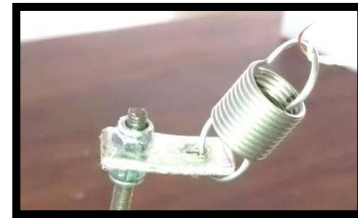
Fig. 2.25 Pieza de acoplamiento hecha con lámina de aluminio.
