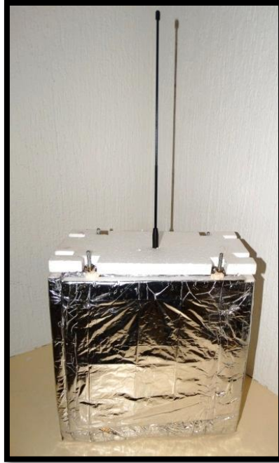
Fig. 2.36 CSM-UNAM. Aparece la antena que permite su seguimiento y su rastreo.
