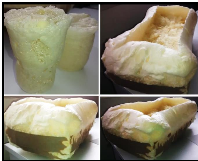
Fig. 2.4 Maqueta del sistema atenuador de impacto con espuma de poliuretano.
