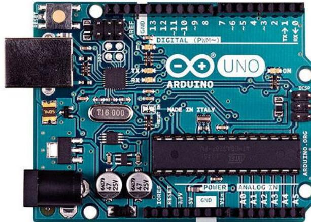
*Fig. 3.3.3 Vista superior del Arduino Uno*
