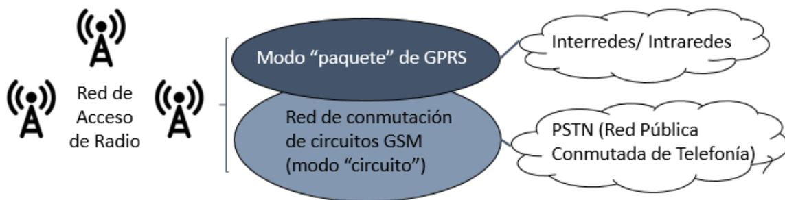
Fig. 2.2.11 Paquetes de datos GPRS añadidos sobre las redes existentes
