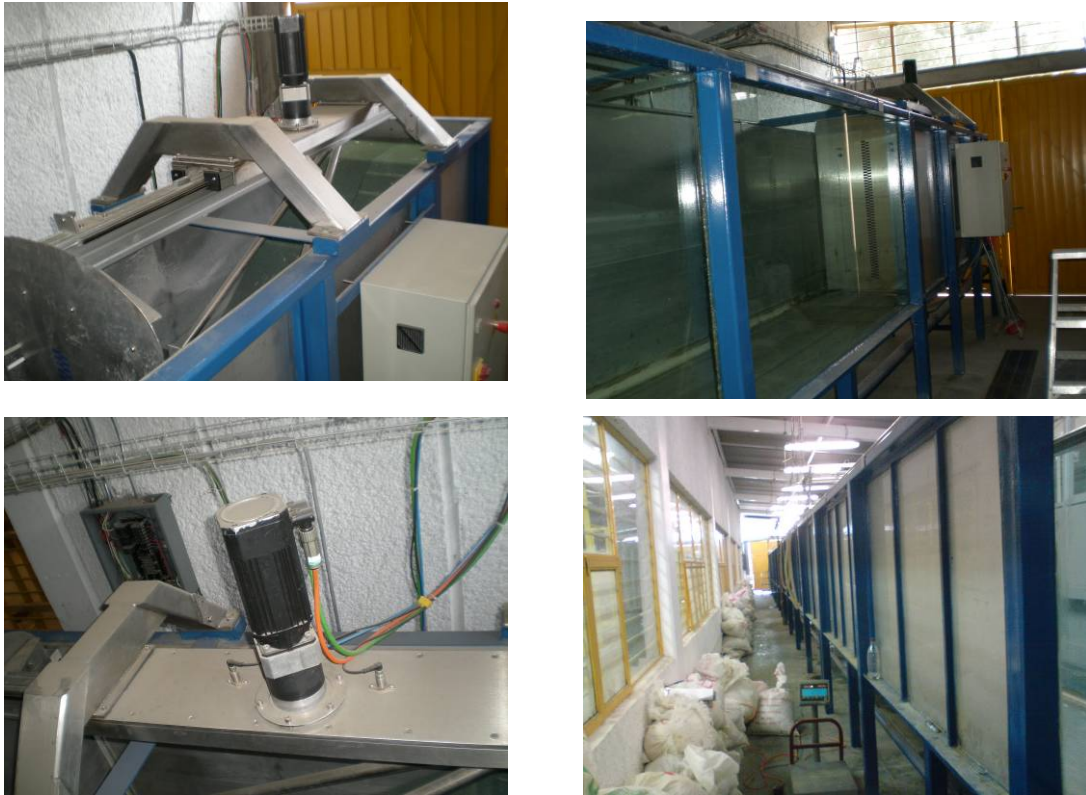
Figura IV.1 a) Riel del sistema generador de oleaje, b) Servo motor del sistema generador, c) Pala del sistema generador de oleaje y d) Vista lateral del canal.
