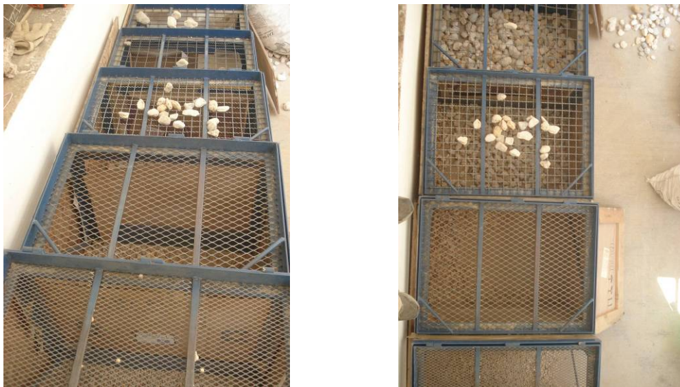
Figura IV.2 Tamices empleados para separar la grava.
