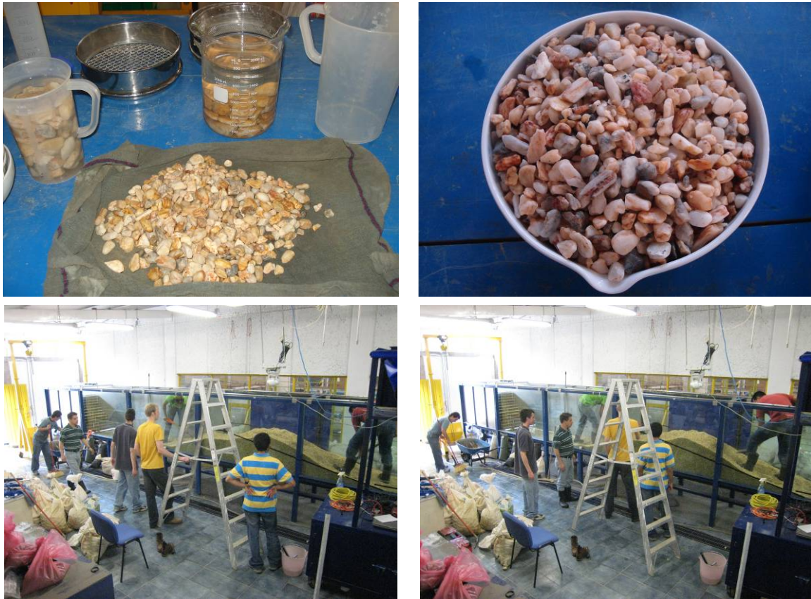
Figura IV.3 Muestras del material (Sup) y construcción de la playa (Inf).
