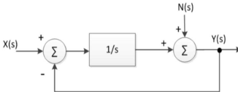
Figura 2.48. Modulador sigma-delta en el dominio de Laplace.
