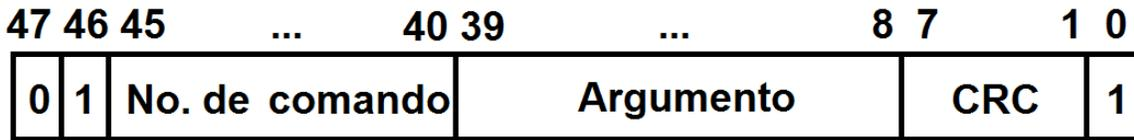
Figura 2.74. Formato de comando válido en el modo SPI.
