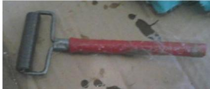
Figura 30. Rodillo utilizado para la operación de rolado, Fuente Propia
