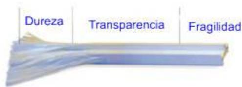
Figura 22. Hilo fibra de vidrio, Fuente <http://www.maquinariapro.com/materiales/fibra-de-vidrio.html>
