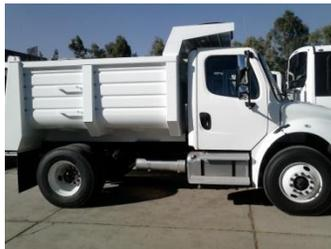
Figura 4. Unidad de volteo Freightliner con caja tipo Góndola 7 metros, Fuente Propia
