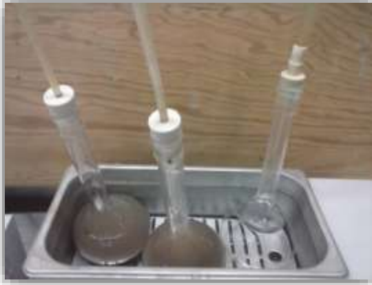
Ilustración 20. Método para la determinación de la densidad de arena y finos.
