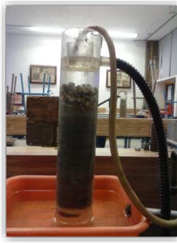
Ilustración 19. Prueba de permeabilidad a carga constante.
