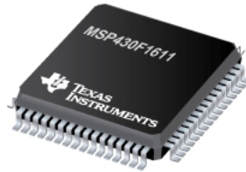
Figura 4.14: Imagen del microcontrolador del Subsistema de Potencia Eléctrica
