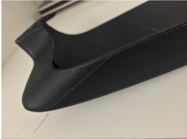
Imagen 3.6. Ejemplo de línea de partición en una pieza plástica.
