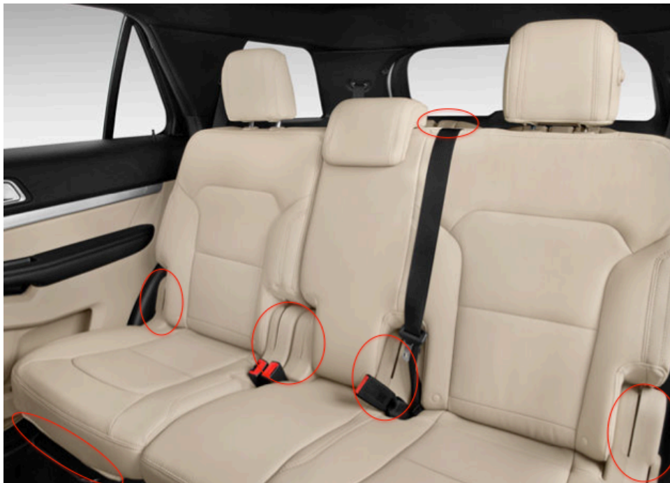
Imagen 3.1. En círculos rojos: Ejemplo de componentes de plástico en el asiento de un Ford Explorer [5].
