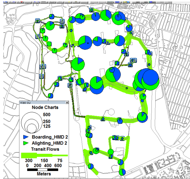
Figura 4.2.2 Ascenso y descenso de pasajeros en las paradas del Pumabús- Asignación SUE entre las 15-16 horas
