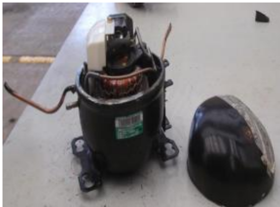
Ilustración 3.2. Corte de carcasa
