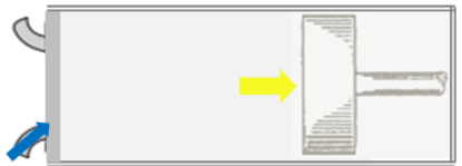
Figura 2.3. Ciclo de compresión de un compresor recíprocante.
