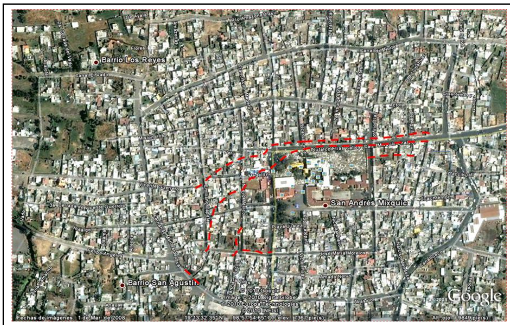
Figura 5.83.- Trazo de la fractura principal en la Calle Plutarco Elías Calles la cual afecta varias casas, dos iglesias y al panteón. Pueblo de San Andrés Mixquic (Modificado de Google, 2010).
