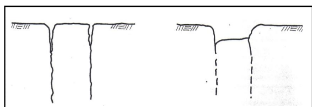
Figura 5.91.- Par de grietas, antes (izq.) y después (der.) de lluvia o sismo (Santoyo, 2009).
