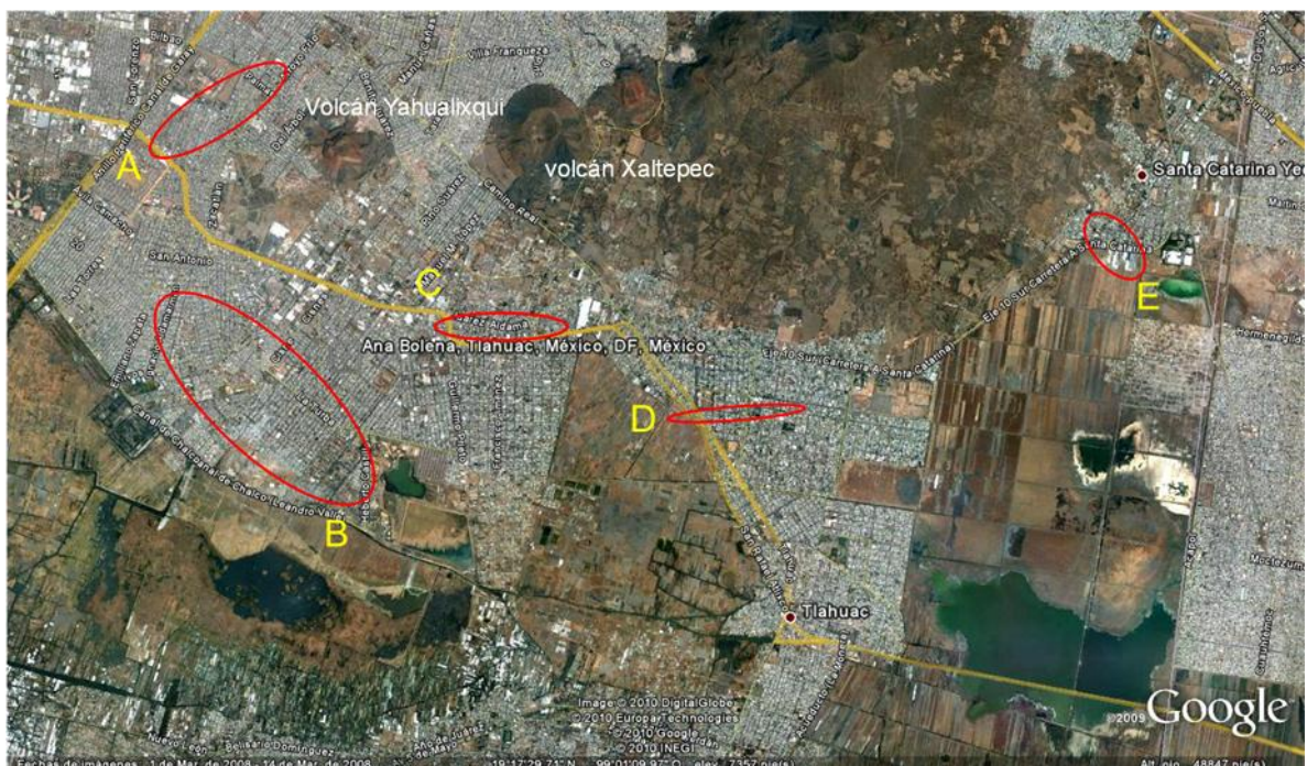
Figura 5.65.- Localización de las trazas principales de fracturamiento en el suelo, que afectan progresivamente a viviendas en la periferia de la Sierra de Santa Catarina (Modificado de Google, 2010).
