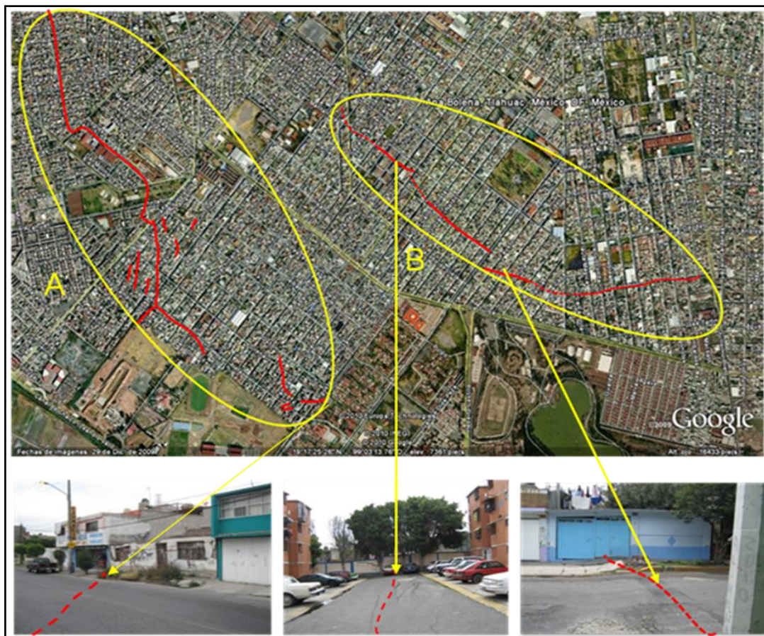
Figura 5.75.- Localización de las trazas principales del agrietamientos en el suelo, que afectan progresivamente a viviendas de las colonias Del Mar, Agrícola Metropolitana y Miguel Hidalgo en la Delegación Tlhuac (Modificado de Google, 2010).
