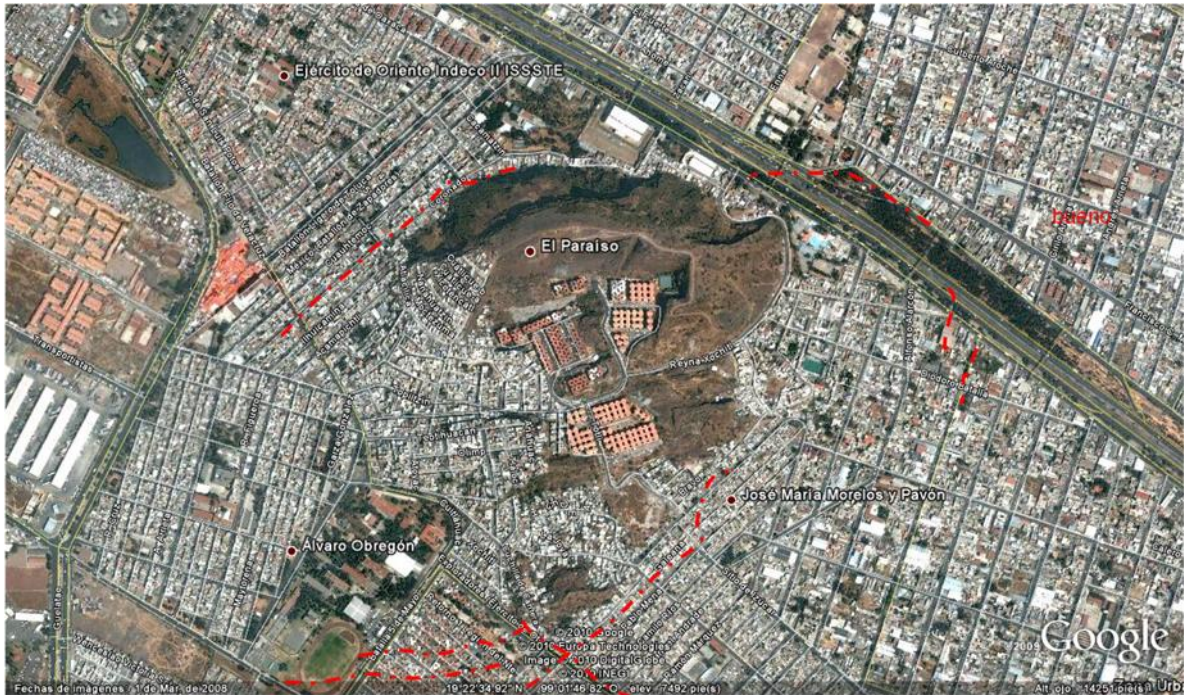
Figura 5.58.- Localización de los crecimientos dimensionales de las trazas del fracturamientos en el suelo, que afectan progresivamente a viviendas de las colonias circundantes al Peñón del Márquez en la delegación Iztapalapa (Modificado de Google, 2010).
