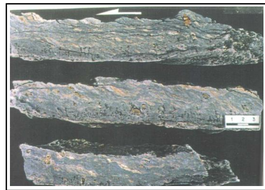
Fig. 3.25: Ejemplos de "gouge" en una falla con movimiento sinistral, en material "cohesivo" modificado por la circulación de fluidos hidrotermales del sureste de España (Doblas, 1997).
