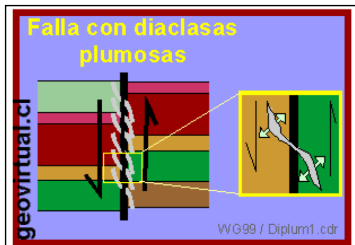
Fig.3.6.- Diaclasas plumosas de cizalla (Tomado de W. Griem; digital 2006).
