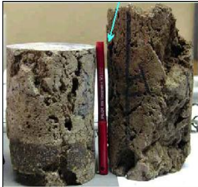
Fig.3.48.- Muestras de núcleos con fracturas interco-nectando vugulos (Tomado de: Cinco Ley. 2006).
