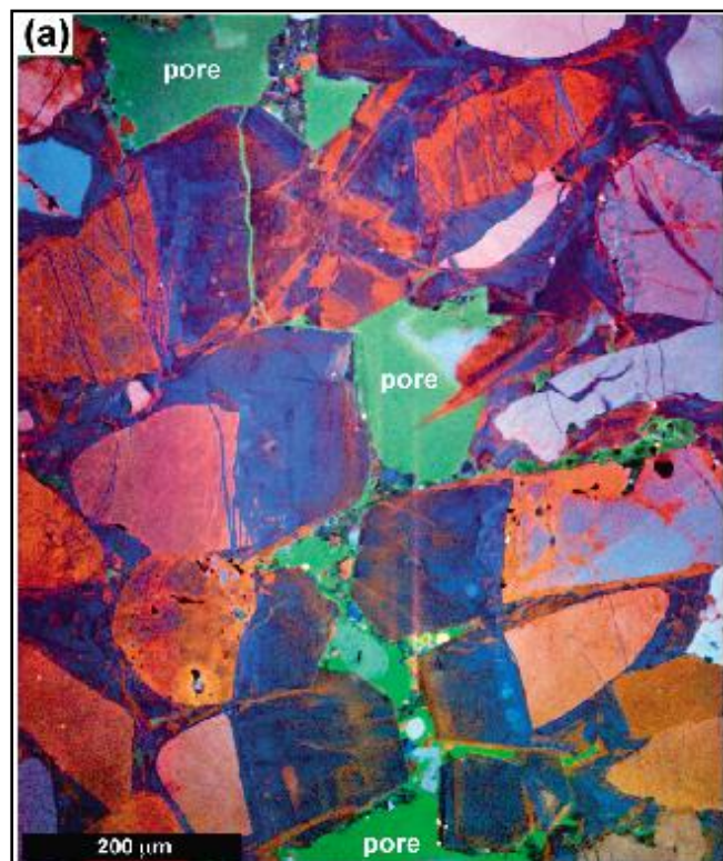
Figura 3.52.- Imagen en catodoluminiscencia en color mostrando el centro de una macrofractura. El área de la imagen es de aproximadamente de 12 mm 2 . Se observan granos de cuarzo dentro de una cuarzoarenita cementada, con una profundidad de 3008.8 m, del Cretácico. Formación Travis Peak Texas (Tomado de Laubach, 2004).
