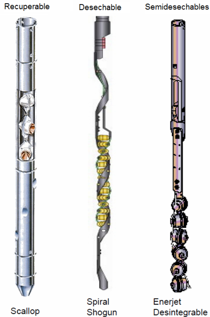
Figura 3.10 Pistolas bajadas con tubería
