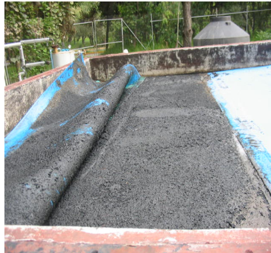
Figura 5-28. Formación de nata 24 horas después de que se alimentó al digestor
