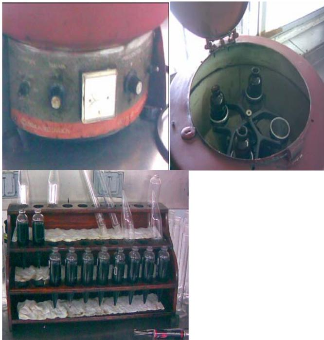
fig.4.1. Equipo centrífugo para medir la cantidad de agua separada del aceite, así como los sedimentos del mismo.
