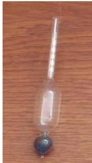
Figura 1.2. Hidrómetro o densímetro.
