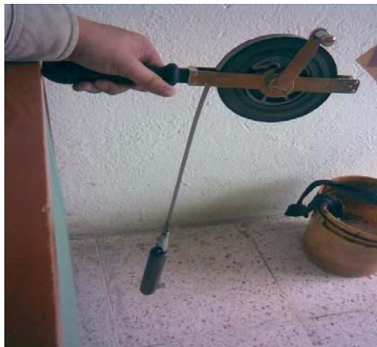
Fig. 6.5 Medidor de nivel con plomada.
