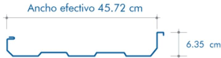
Figura 47. Ancho efectivo y peralte de lámina KR-18
