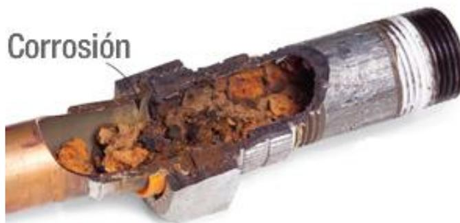
*Figura 1.13 Corrosión en tubería<sup>14</sup>*
