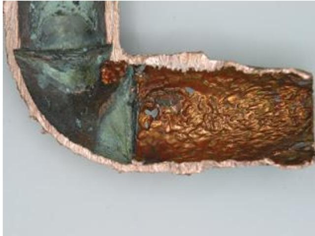
*Figura 1.12 Ejemplo de severa erosión por cavitación en una tubería.<sup>13</sup>*
