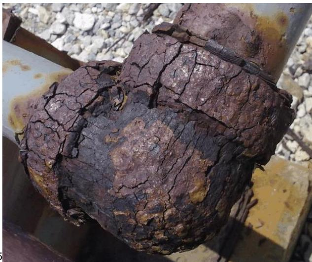
15 *Figura 1.14 Tubería que presenta corrosión por erosión.*<sup>15</sup>
